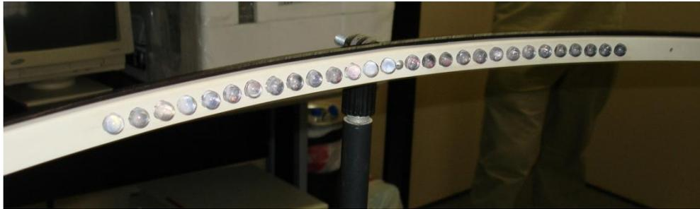
*Figura 1: Barra composta por 30 díodos emissores de luz (LEDS)*
