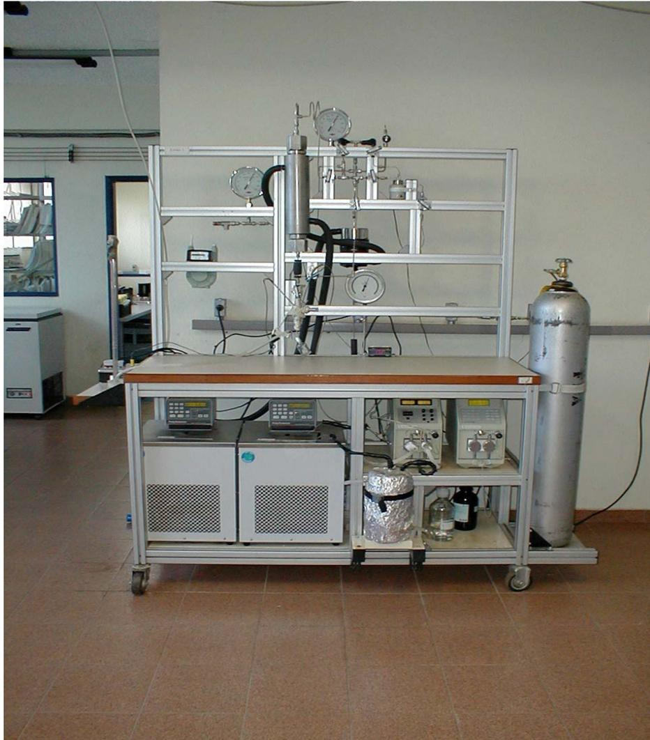
Figura 22: Aparelho de extração por fluido supercrítico, Laboratório de Engenharia de Alimentos (LASEFI), UNICAMP/Campinas
