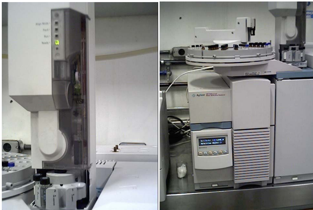
Figura 12: Cromatógrafo com fase gasosa acoplado ao espectrômetro de massas (FIOCRUZ).
