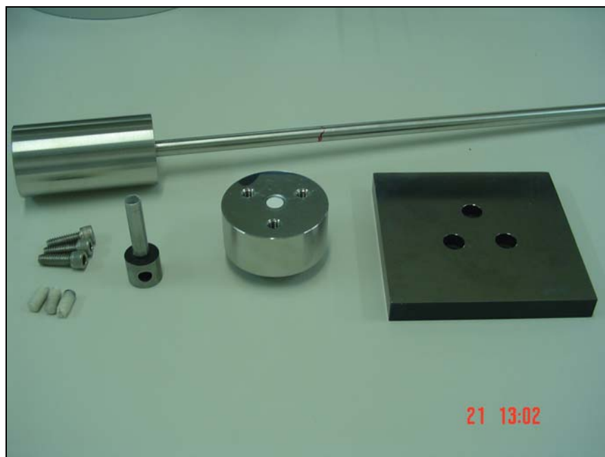
Figura 2- Desenho técnico (a) e fotografia (b) do dispositivo para estabelecimento da dissolução intrínseca em disco.
