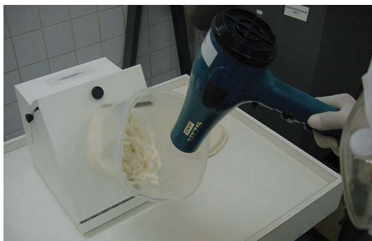
Figura 20. Etapa IV: Demonstração do teste de direcionamento correto do fluxo de ar no tambor.
