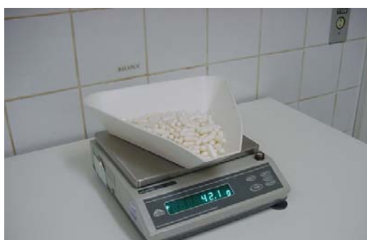
Figura 18: Etapa I - Pesagem das cápsulas vazias para cálculo da quantidade de polímero a ser empregada.
