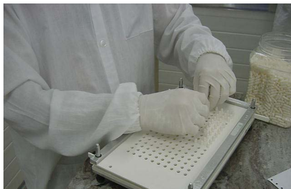
Figura 19. Etapa II - Preenchimento das cápsulas vazias com mistura de diclofenaco sódico e excipientes.
