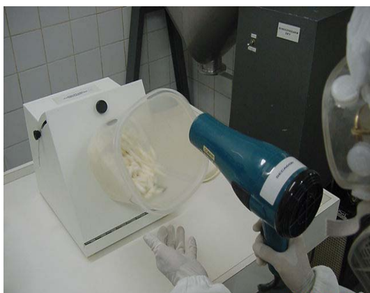
Figura 21. Demonstração do teste de direcionamento errado do fluxo de ar, promovendo a projeção das cápsulas para fora do tambor durante o procedimento de revestimento.
