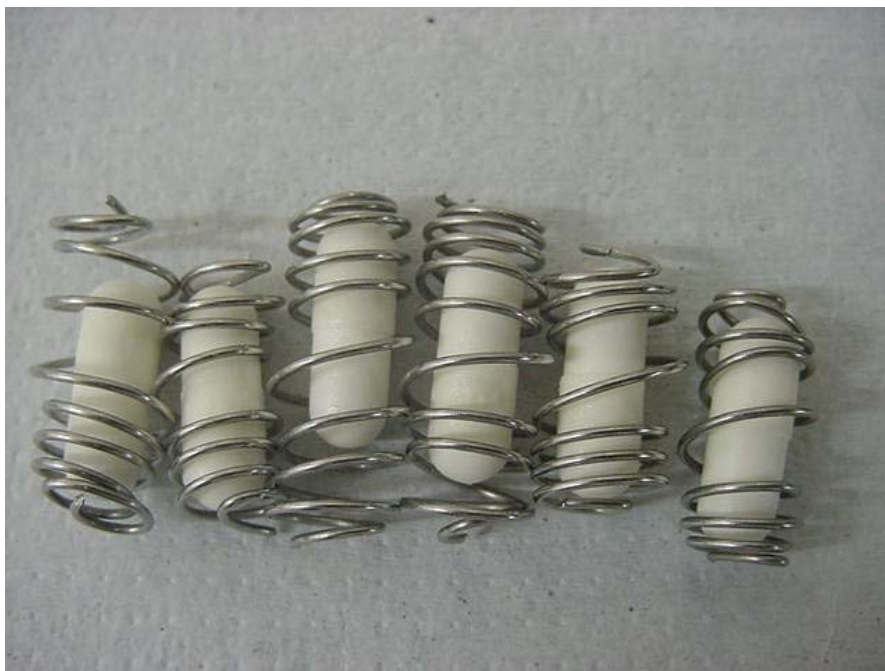
Figura 23. Peça helicoidal de aço inox para evitar a flutuação das cápsulas no meio de dissolução (MURTHY, 1993; USP, 2005).
