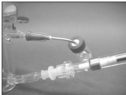
Figura 3.2 Detalhe do sistema de amostragem da célula de Franz.
