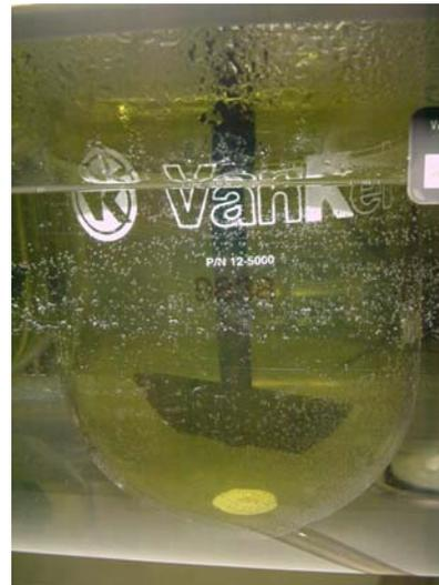
Figura 22 – suspensão de NMS no fundo da cuba
