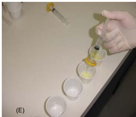
Figura 6 – Ilustração do procedimento de adição das suspensões e coleta das amostras do meio no ensaio de dissolução. (A) seringas numeradas com a suspensão a ser adicionada; (B) adição da suspensão à cuba; cânula, filtros e seringas para coleta manual do meio de dissolução; (C) seringas numeradas acopladas as cânulas com os filtros cilíndricos para a coleta; (D) coleta do meio e (E) filtração imediata do meio através de membrana 0,45  $\mu\text{m}$ .
