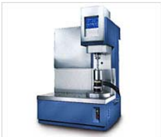
Figura 15 - Reômetro ARES -TA utilizado nas medidas de viscosidade.
