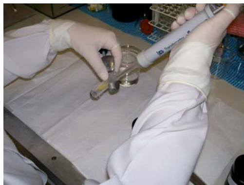
Figura 18 - Aplicação da amostra de formulação no compartimento doador do sistema de difusão.
