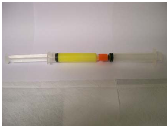
Figura 12 - Mecanismo de extrusão: o conteúdo das seringas foi homogeneizado empurrando-se lentamente um êmbolo por vez.
