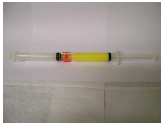
Figura 12 - Mecanismo de extrusão: o conteúdo das seringas foi homogeneizado empurrando-se lentamente um êmbolo por vez.
