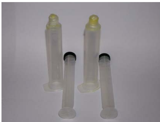
Figura 10 - Seringas tipo luer lock com o corpo vedado com parafilme na extremidade anterior.
