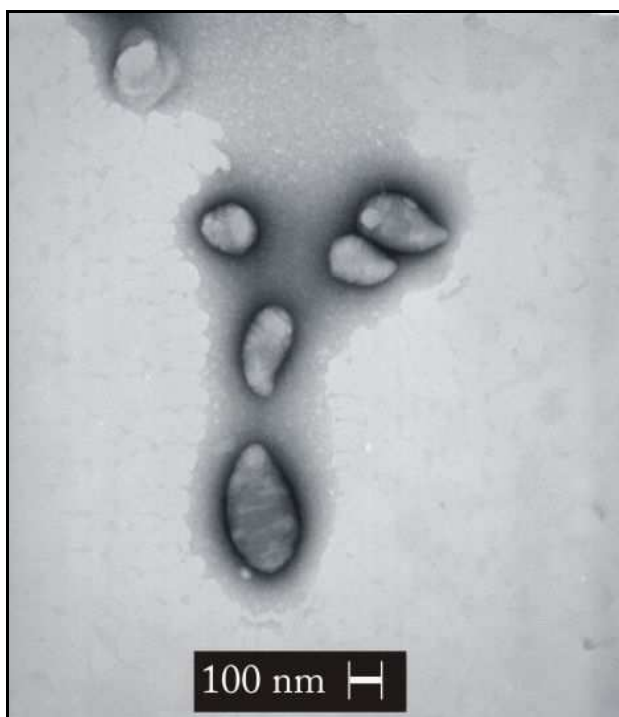
Figura 25. Micrografia eletrônica de Np de PCL contendo L-triptofano. Barra de aumento: 100 nm.
