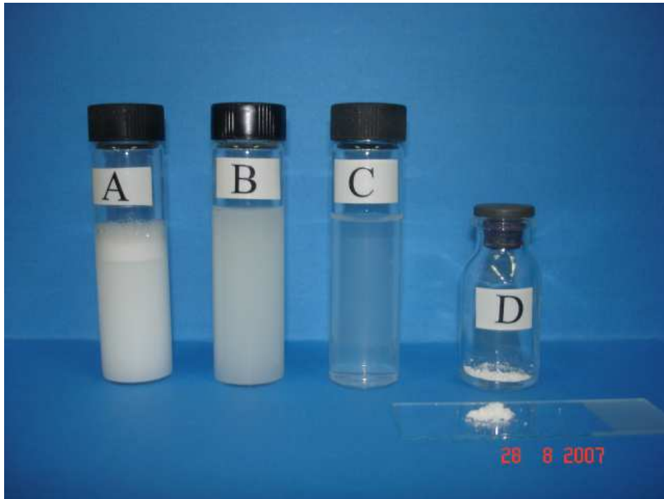
Figura 20. Aspectos macroscópicos na preparação de nanopartículas (Np) de poli- \epsilon -caprolactona (PCL).
