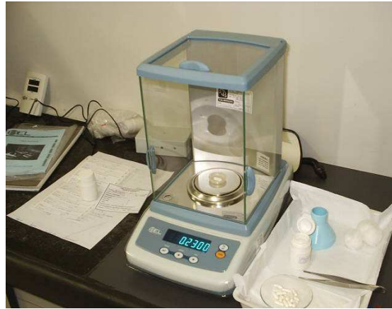
Figura 13: Teste de determinação de peso nas amostras de cápsulas. Laboratório de Controle de Qualidade. Farmácia-Escola/UFRJ. (por Gláucia M. Pinheiro, 2007)
