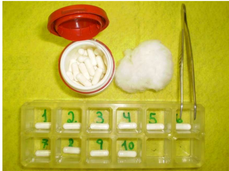
Figura 14: Suporte de acrílico utilizado no teste de uniformidade de dose (por Gláucia Pinheiro, 2007)
