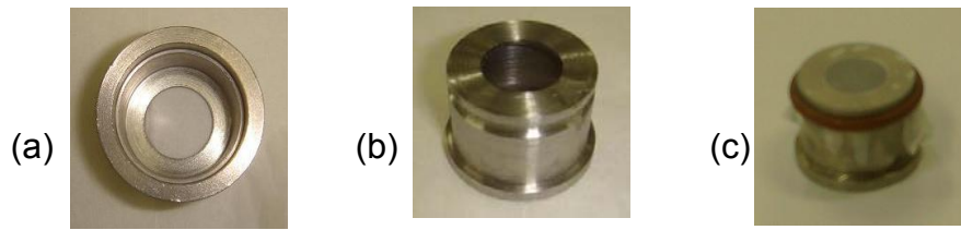
Figura 13: Suporte da amostra: visão interna da área útil (a); visão da parte inferior da área útil (b) e suporte com membrana disposta e presa com anel de borracha (c).
