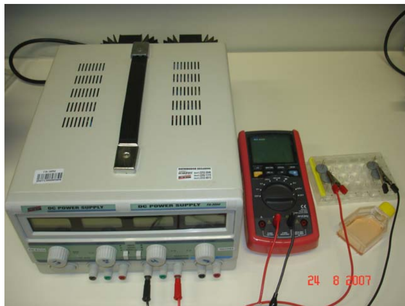
Figura 5: Sistema experimental para estímulo elétrico. À esquerda: Fonte geradora de CE; no centro: multímetro digital; à direita: garrafa para cultivo de células e placa acrílica com tampa removível a qual foram adaptados eletrodos de platina e cabos condutores.
