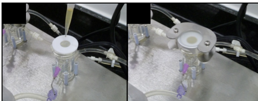
Figura 10 – representação da célula de Franz. A) preenchimento do compartimento doador. B) Célula de Franz totalmente montada.
