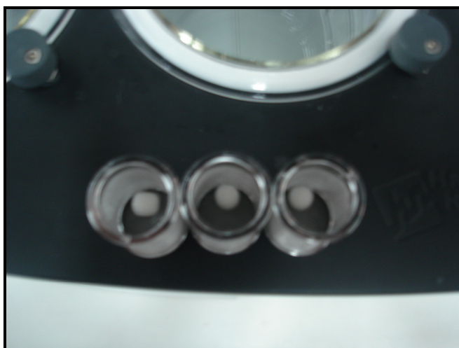
Figura 23. Fotografia de comprimidos intumescidos da formulação BPD/HPMC 1:3 ao final de 60 min do ensaio de dissolução.
