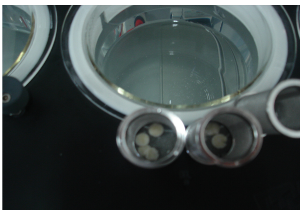
Figura 26. Fotografia dos resíduos laminados dos comprimidos da formulação de BPD/VCG 1:3, após 60 min do ensaio de dissolução.
