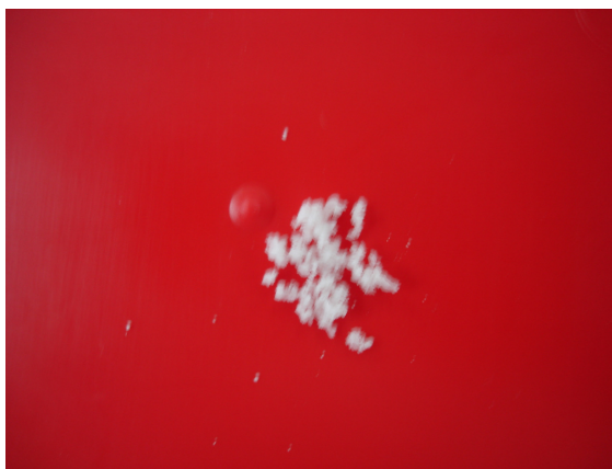
Figura 27. Fotografia de resíduos insolúveis dos comprimidos da formulação BPD/EC 1:3, retirados da cesta após 60 min do ensaio de dissolução.
