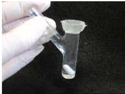
Figura 7: Célula de difusão vertical do tipo *Franz*, com o tecido animal posicionado sobre o compartimento receptor.
