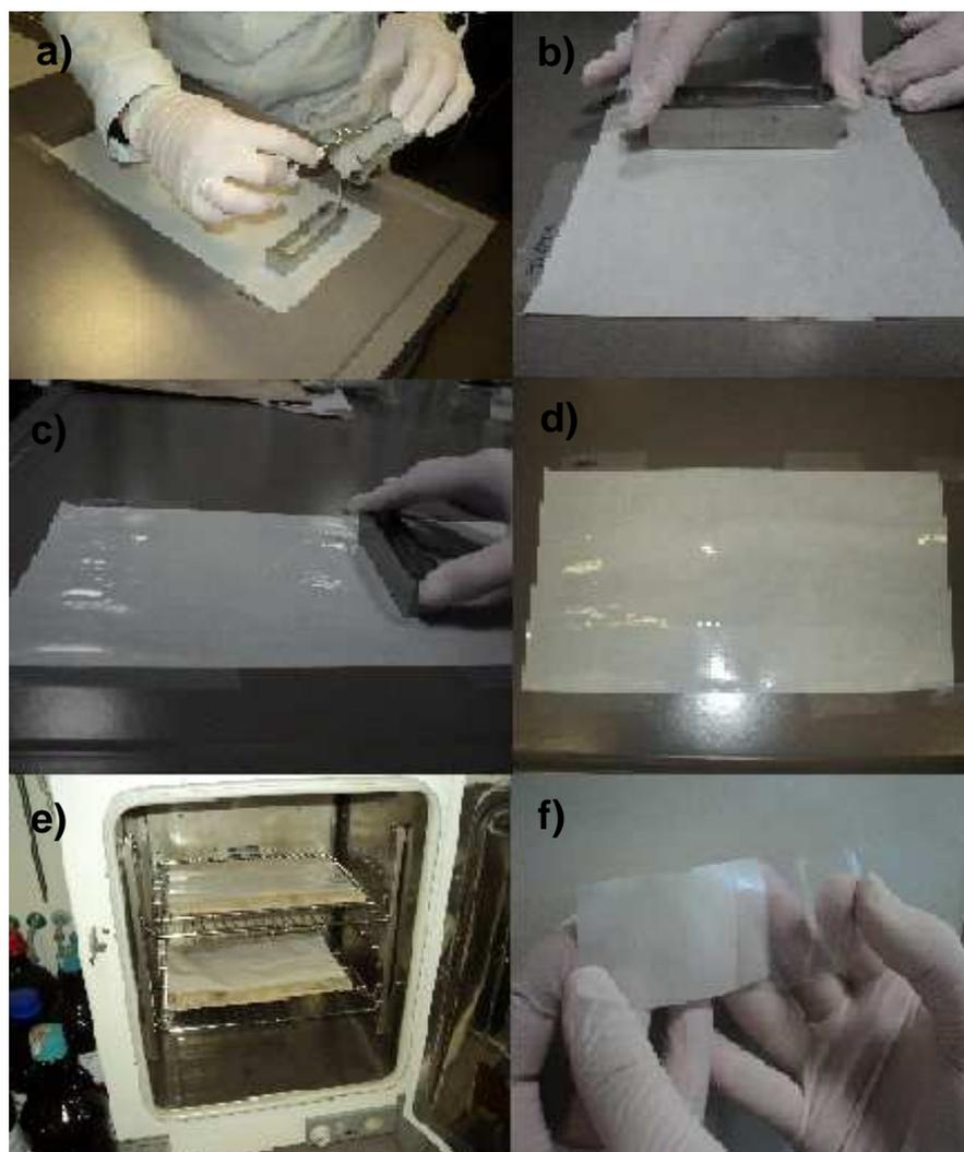
**Figura 5: Técnica de preparação dos filmes Patch-non-Patch®: a) a mistura obtida é depositada dentro da faca moldadora; b e c) é, então, estendida sobre papel siliconizado com o auxílio da faca de 0,45  $\mu\text{m}$ ; d) obtém-se um filme sobre o papel siliconizado; e) o filme é submetido à secagem em estufa a 60°C durante 30 minutos; f) obtenção do Patch-non-Patch®.**
