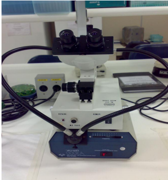
Figura 22. Figura de microscópio binocular acoplado à grátícula e iluminador Fonte: Elaboração própria
