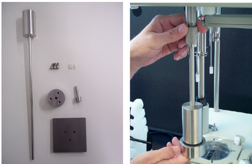
Figura 7. Aparato rotatório de dissolução intrínseca. A) Componentes do Aparato (Equipamento LabCQ). B) Aparato montado para realização de dissolução (Manual da Varian ®).
