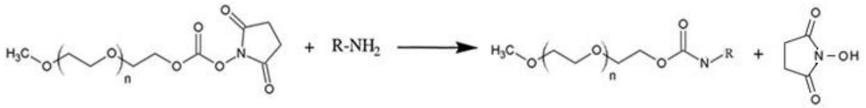
Figura 6: Esquema reacional entre metoxil polietilenoglicol succinimidil carbonato e amina primária.
