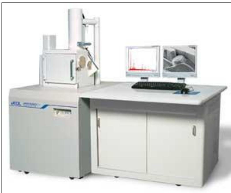
Figura 23: MEV JSM 6490-LV do LabNano do CBPF.
