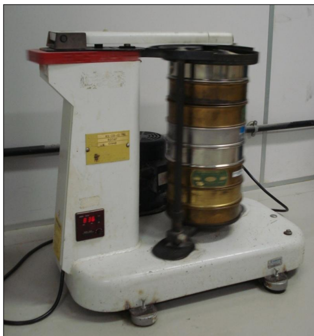
Figura 17: Tamis oscilante da Embrapa utilizado para análise granulométrica de SAR.
