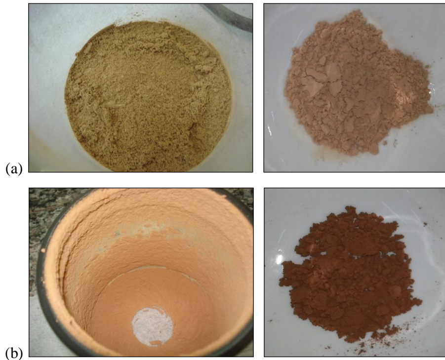
Figura 41: Observação macroscópica das amostras secas pelo spray-dryer , (a) pó atomizado SART, (b) pó atomizado SARFlora.
