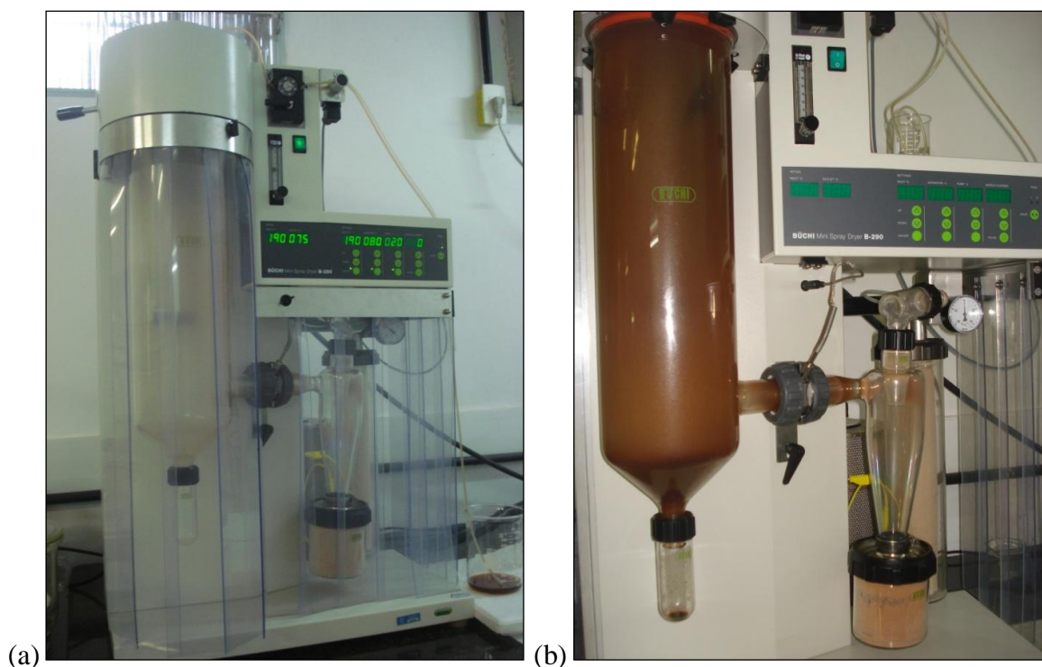
Figura 39: Processos de secagem no spray-dryer , sendo (a) secagem de SART, (b) secagem de SARFlora.
