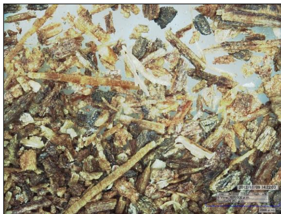
Figura 36: Detalhe dos diferentes tamanhos de partículas encontradas no pó da casca de SAR com aumento de 40x e a barra de escala de 2000\mu\text{m} .
