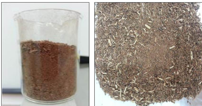
Figura 33: Observação macroscópica das partículas obtidas após moagem da SAR.
