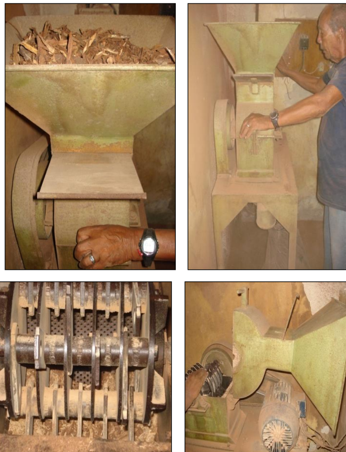
Figura 14: Moinho de martelo do NPPN/UFRJ utilizado para moagem das cascas de SAR e detalhes. Fonte: acervo pessoal.
