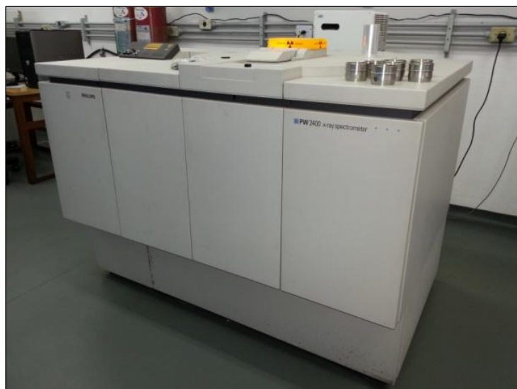
Figura 22: Aparelho de Fluorescência de RX PW 2400 X-ray spectrometer – Philips do Instituto de Geociências/UFRJ.
