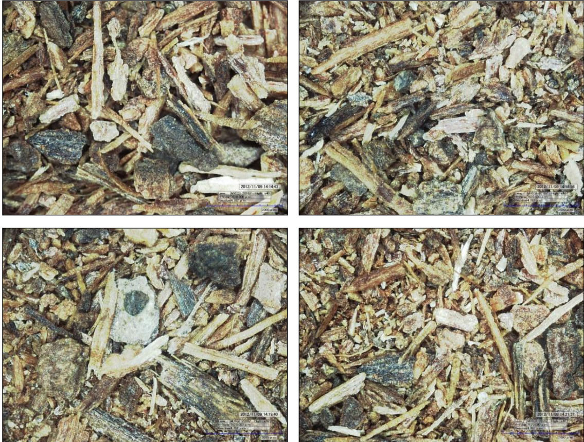
Figura 35: Diferentes tamanhos de partículas encontradas no pó da casca de SAR visualizadas por microscópio digital com aumento de 40x e a barra de escala de 2000\mu\text{m} .
