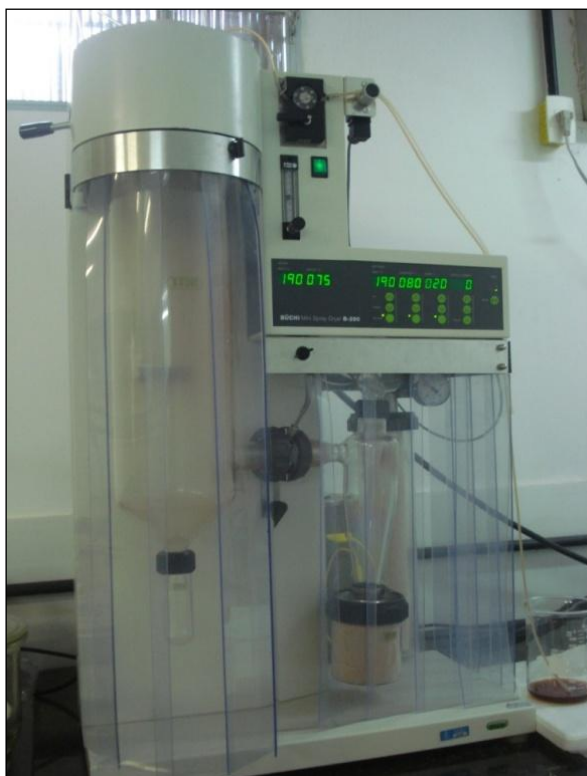
Figura 26: Mini spray-dryer Büchi-290 do Laboratório DAFEE/UFRJ utilizado para os processos de secagem por atomização de SART e SARFlora.
