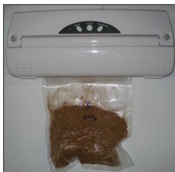
Figura 15: Amostra de SAR embalada a vácuo (seladora “vacuum sealer” da EZ Home).
