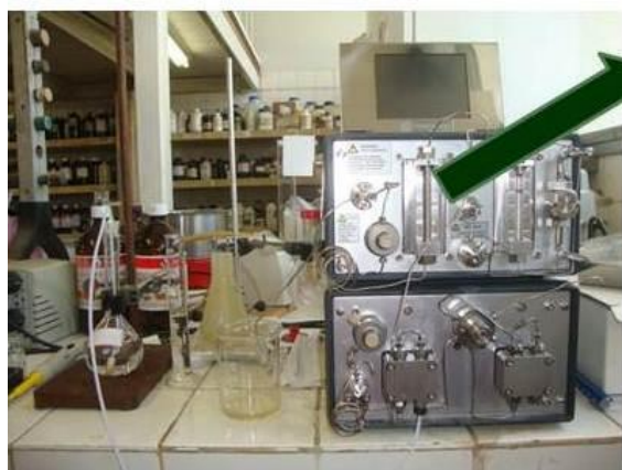
Figura 46: Reator de Leito fixo utilizado na etapa inicial de investigação da reação de formação da MEP catalisada pela lipase RM IM. Condições: AE/IPG 1:1 (35mM) em n-heptano, 60°C .
