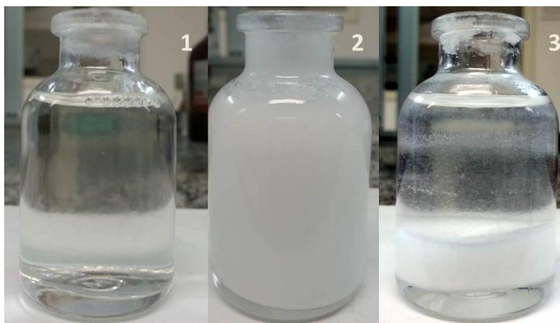
Figura 70: solução contendo o produto final da reação em cascata para a formação da monoestearina sob condições de fluxo contínuo. 1 - monoestearina recém-recolhida a 60°C, 2- início da precipitação do produto a 40°C; 3- decantação do produto em n-heptano.
