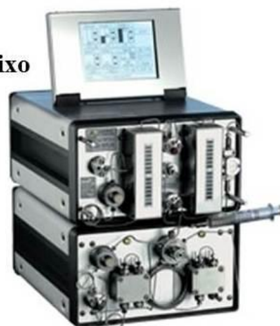
Figura 46: Reator de Leito fixo utilizado na etapa inicial de investigação da reação de formação da MEP catalisada pela lipase RM IM. Condições: AE/IPG 1:1 (35mM) em n-heptano, 60°C .
