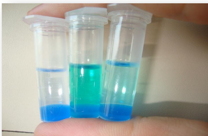
Figura 26: Ensaio de Lowry-Tinsley antes e depois da reação. A) Ensaio em branco, com n-heptano; B) Solução inicial de AE e IPG; C) Reação de esterificação, evidenciando a redução de intensidade do complexo formado na fase superior.
