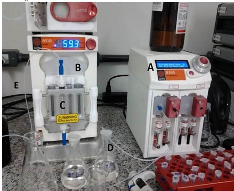
Figura 49: Equipamento para reação em fluxo contínuo (Asia – Syrris); (A) bomba peristáltica de vazão; (B) aquecedor com termostato; (C) coluna cilíndrica de leito fixo recheada com biocatalisador; (D) substratos; (E) saída do produto reacional.
