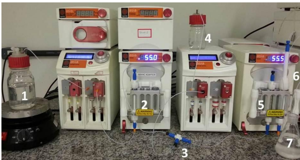
Figura 69: Esquema da reação em cascata para a formação de monoestearato de glicerila, evidenciando o acoplamento de todas as etapas envolvidas. 1 – suspensão acetona/glicerol; 2 – coluna de leito fixo contendo SGF para a acetalização do GL; 3 – conexão para a retirada de produtos da primeira etapa; 4 – IPG e em n-heptano; 5 – coluna de leito contendo a lipase RM IM para a esterificação de IPG com AE; 6 – coluna de leito fixo contendo SGF para a quebra dos acetais do MEP; 7 – MONOEST em n-heptano, evidenciando sua precipitação após o resfriamento.
