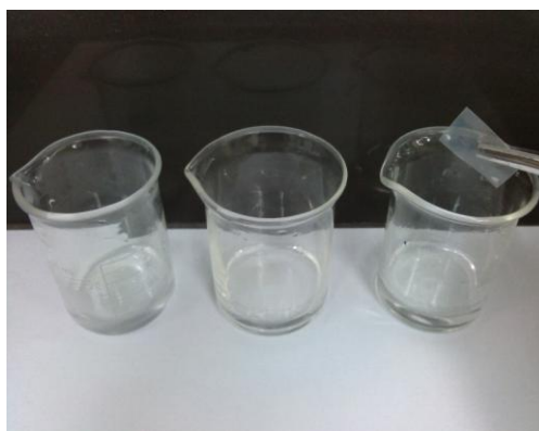
Figura 51. Imagem do estudo de absorção dinâmica realizado com a membrana polimérica do nanocompósito EC:VS4 (3%; 1 h).
