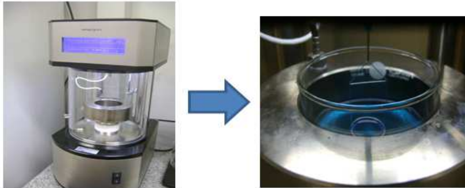
Figura 13 – Imagem do tensiômetro e do procedimento de medida da tensão superficial das soluções preparadas para análise da molhabilidade do diazepam (Fonte: próprio autor).
