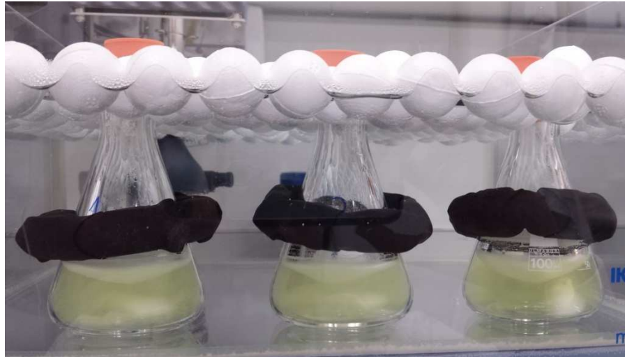
Figura 43 – Ensaio de solubilidade do diazepam em meio HCl 0,1M (Fonte: próprio autor).
