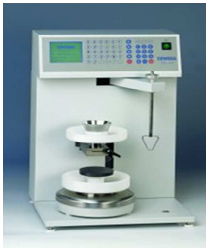
Figura 4 – Imagem do equipamento de análise de fluxo (escoamento de pó e ângulo de repouso) (Fonte: http://www.erweka.com/en/products/gt.html ).
