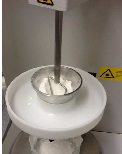
Figura 26 – Imagem após o teste de escoamento do pó de uma das três amostras de matéria-prima diazepam (Fonte: próprio autor).
