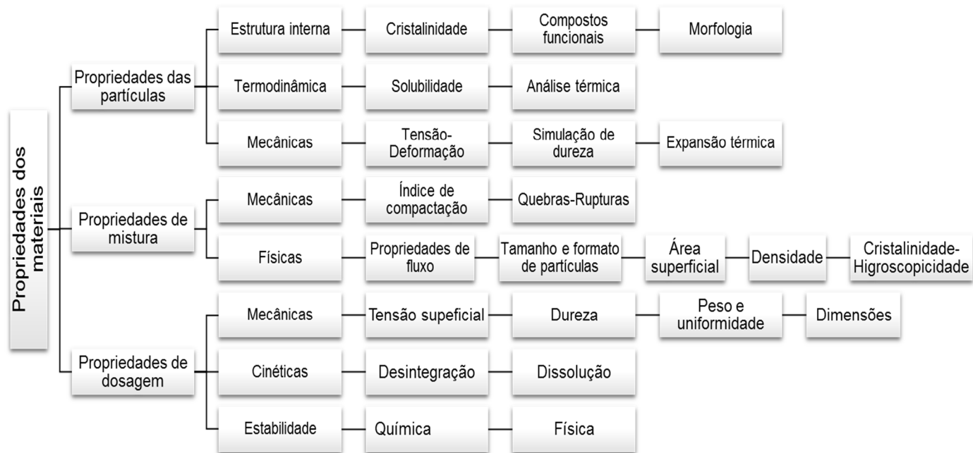
Figura 1 – Propriedades dos materiais e principais características que influenciam a estrutura da própria partícula, a mistura de materiais e a formulação (adaptado HAMAD et al. , 2010).
