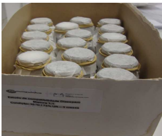
Figura 17 - Acondicionamento das amostras na câmara climática (Fonte: próprio autor).
