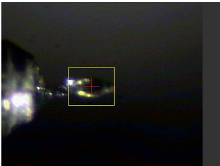
Figura 31 Imagem do cristal de trombina em complexo com 1,8-ANS (em HCSI06). Montado no loop de nylon sob atmosfera de N_2(g) a 100K no goniômetro da linha de luz MX2 do LNLS durante a coleta de dados de difração de raios-X.
