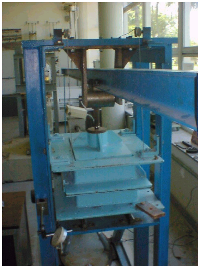
Foto 5.2 – Vista lateral do equipamento de cisalhamento direto de grande porte.
