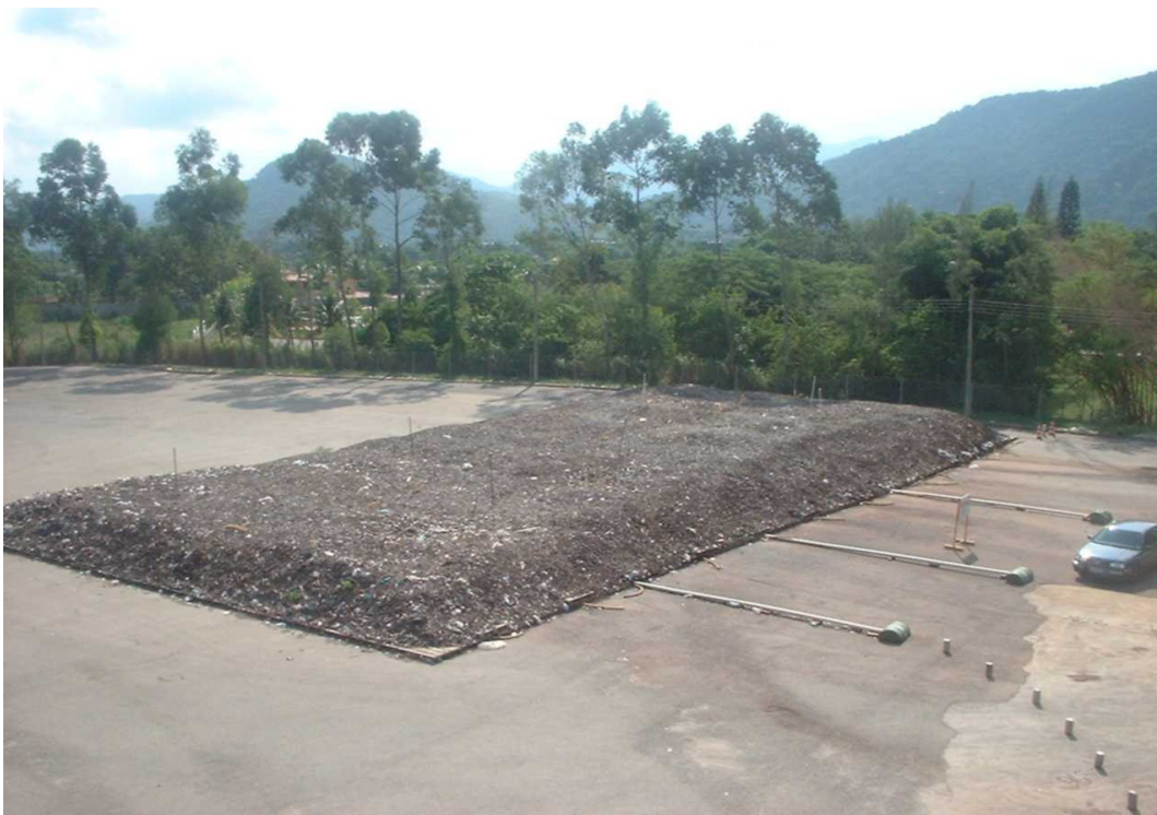
Foto 4.1 – Leira de resíduo do pré-tratamento mecânico-biológico do lixo – Projeto Piloto na usina de Compostagem da COMLURB em Jacarepaguá – Rio de Janeiro.
