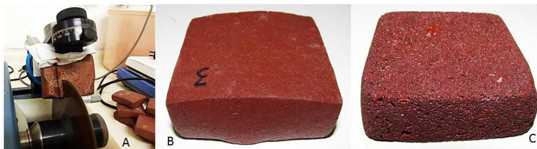
Figura 3.1 -- Cortadora a disco diamantado cortando lâminas de 3 mm de espessura de uma peça íntegra do material (A). Aspecto geral de uma peça íntegra (B). Aspecto geral de uma peça lixada (C).
