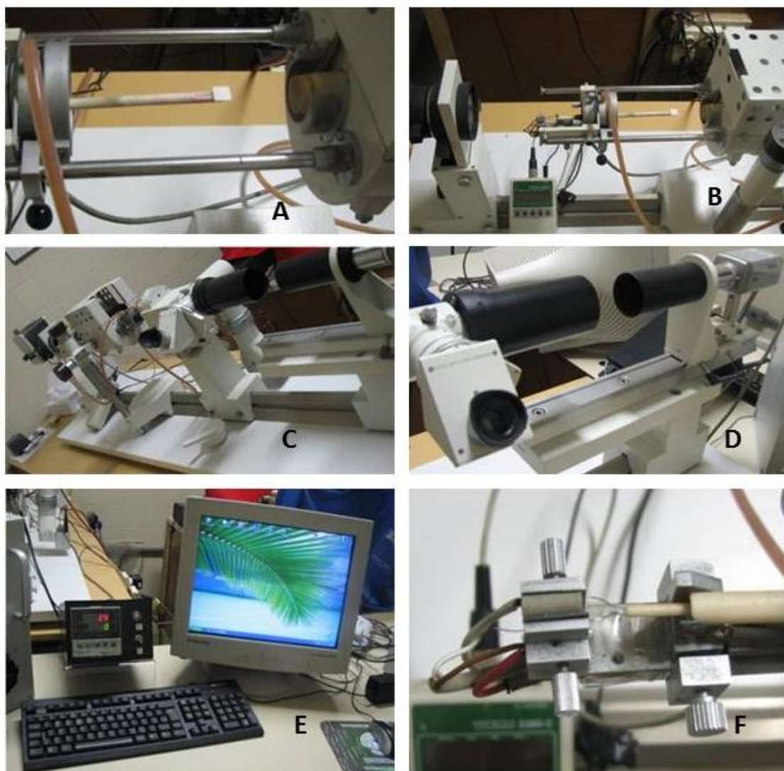
Figura 3.8 – Suporte de amostra e entrada do forno (A). Canhão de luz, termopar, suporte de amostra e forno (B). Canhão de luz, forno, microscópio de aquecimento e medidor de temperatura (C). Microscópio e câmera (D). Estação de trabalho com leitor digital de temperatura (E). Termopar (F).
