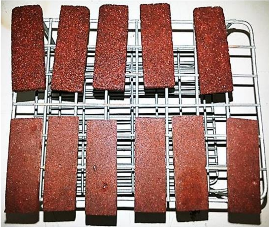
Figura 3.3 - Peças em forma de lâminas medindo 5x1x0,3 cm para ensaios de DMA e de resistência à flexão.
