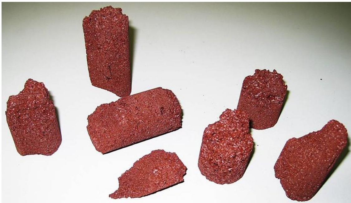
Figura 4.44 – Amostras após ensaios de resistência à compressão.
