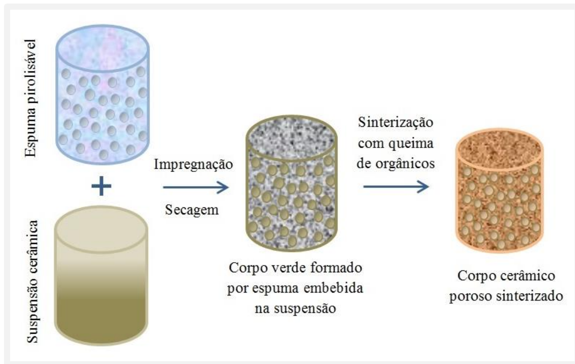
Figura 2.4 – Preparação de espuma cerâmica pelo método de réplica.
