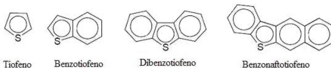
Figura 2.7 – Principais compostos sulfurados envolvidos nas reações de HDS (Adaptado de SILVA, 2007).
