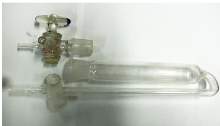
Figura 3.6 – Reator utilizado para síntese das amostras empregadas nas análises de XPS.
