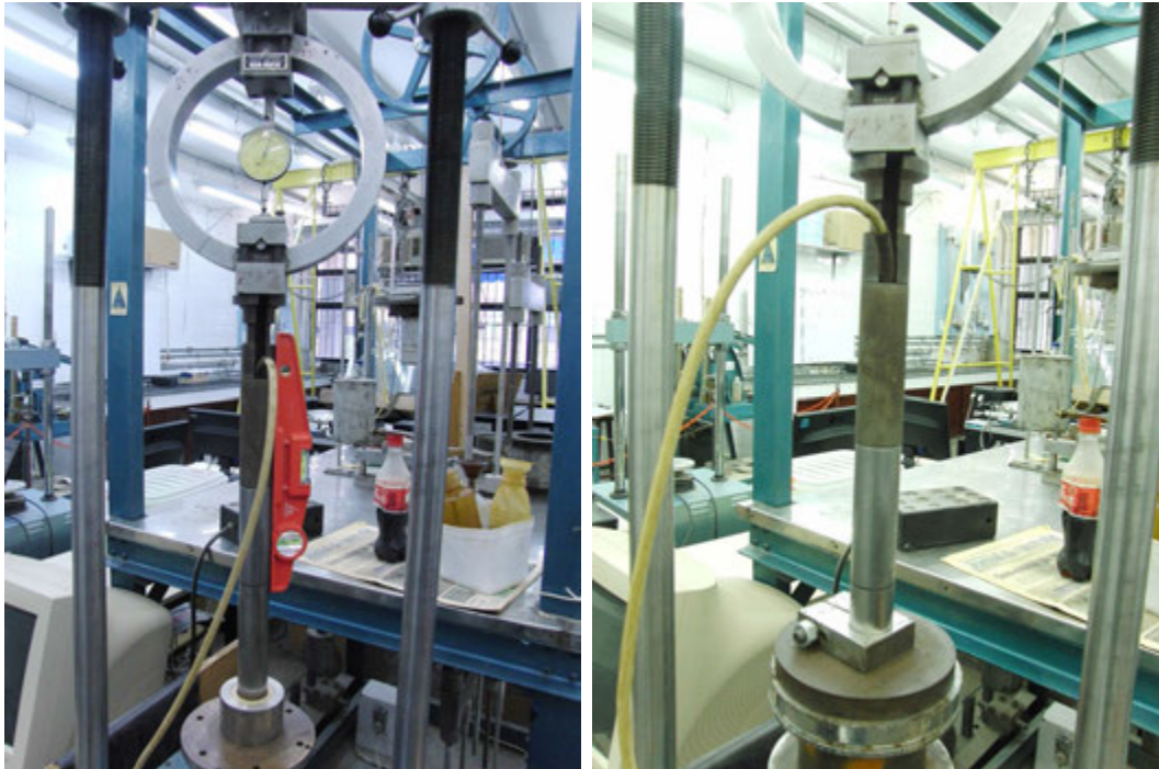
Figura 3.23 – Aparato para calibração de (a) resistência de ponta, (b) atrito lateral.
