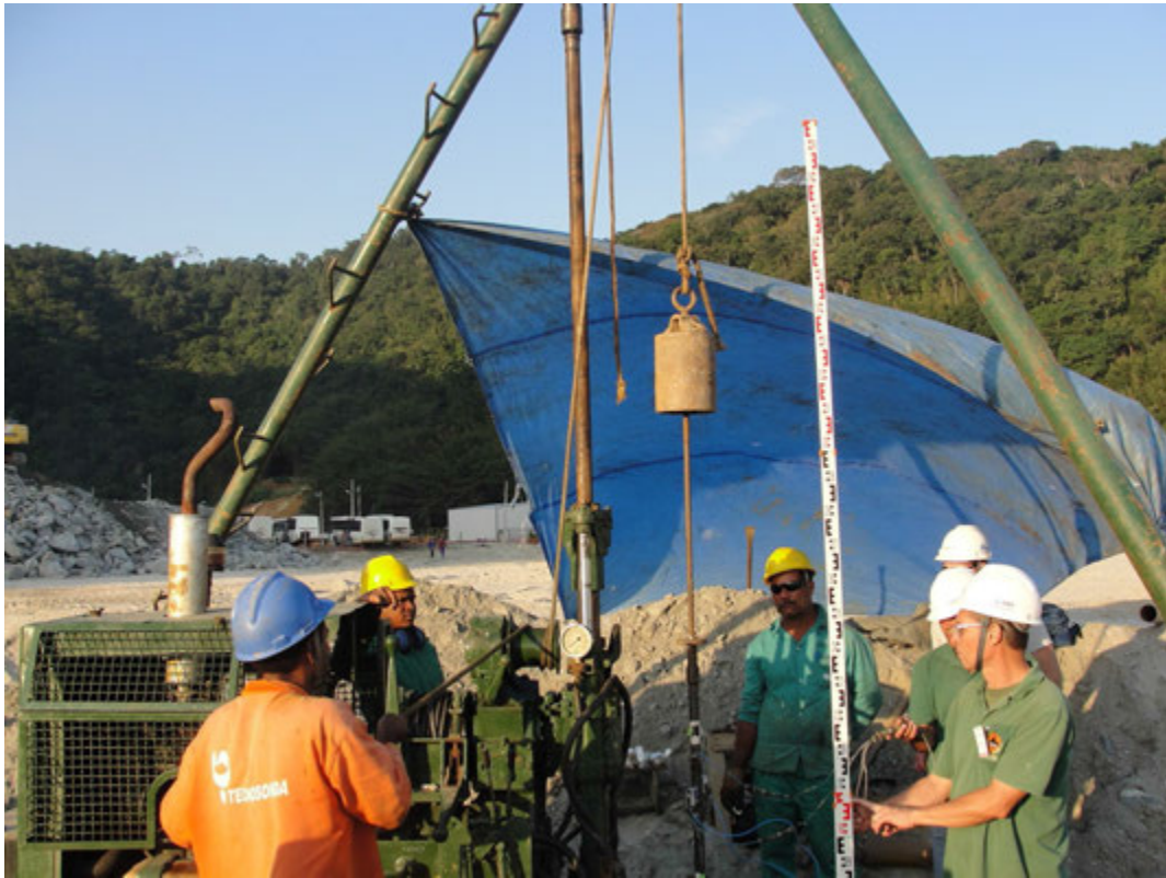
Figura 6.22 – Sistema mecanizado de levantamento do martelo.
