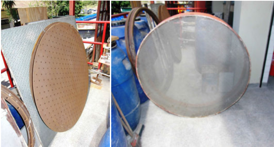
Figura 3.18 – Foto de placas perfuradas (3.18a) e do difusor (3.18b).
