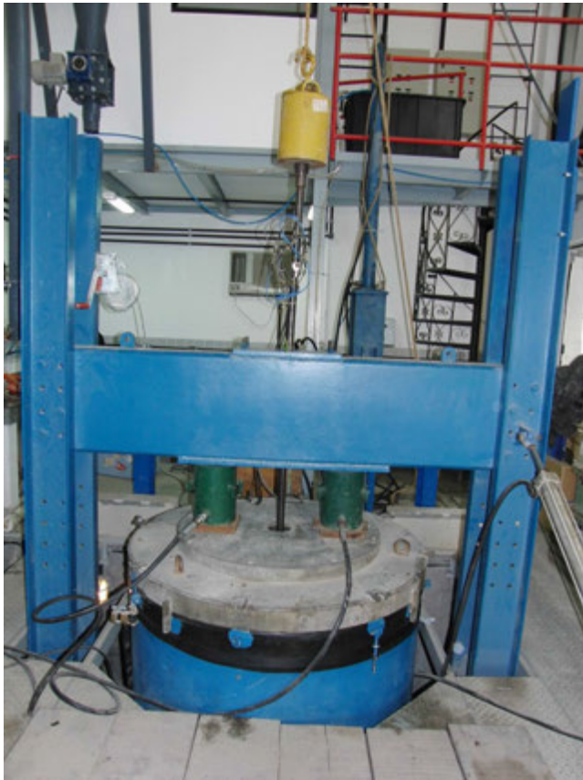
Figura 7.29 – Montagem do ensaio de cravação dinâmica do novo amostrador.
