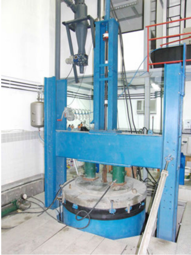
Figura 7.19 – Montagem do ensaio de cravação estática do novo amostrador.
