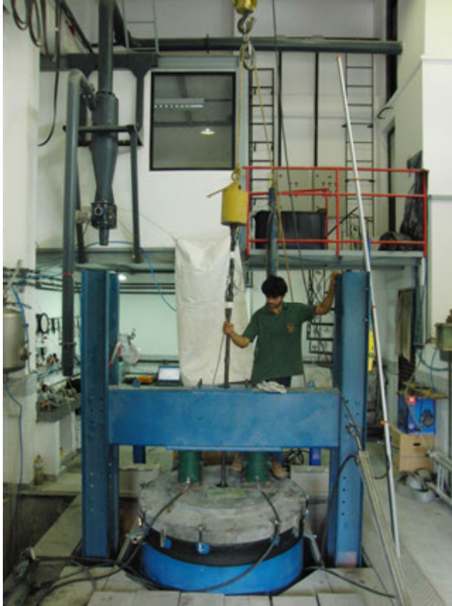
Figura 7.26 – Montagem do ensaio de cravação dinâmica do amostrador SPT.
