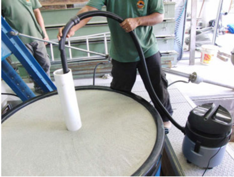
Figura 7.12 – Execução de pré-furo na amostra de areia.
