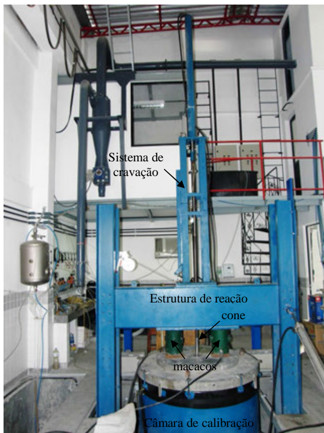
Figura 3.14 – Foto da câmara de calibração NGI-COPPE/UFRJ montada para um ensaio de cone.
