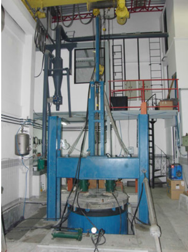
Figura 7.4 – Montagem de ensaio de cone em câmara de calibração.
