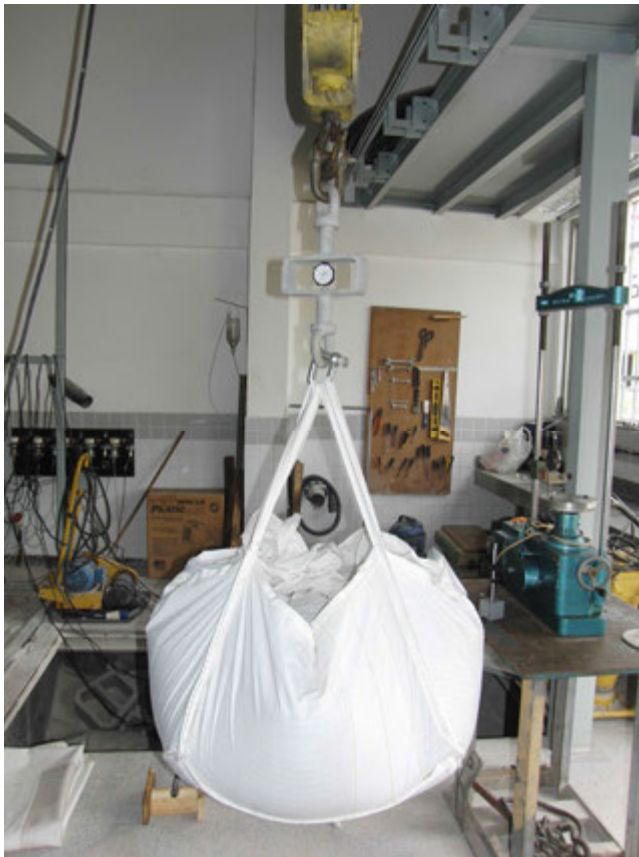
Figura 7.2 – Processo de pesagem da amostra de areia.
