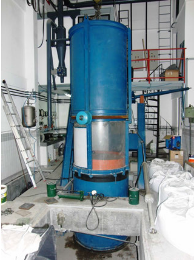
Figura 3.17 – Foto do sistema de pluviação sobre a câmara de calibração NGI-COPPE/UFRJ.
