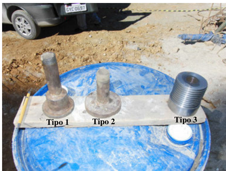
Figura 6.21 – Cabeças de bater utilizadas nos ensaios em Itaguaí.
