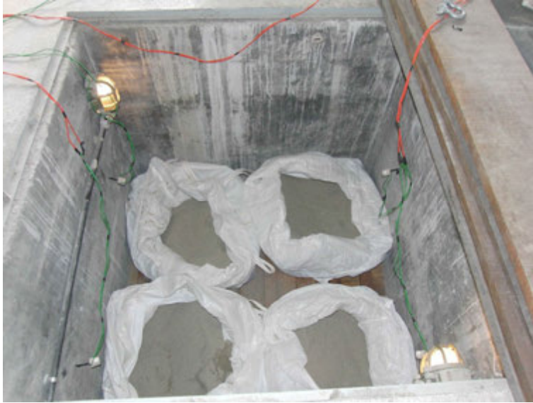
Figura 7.6 – Estufa montada para a secagem da amostra de areia.
