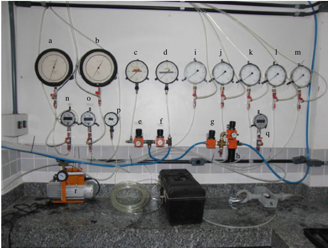
Figura 3.21 – Foto do painel de controle da câmara de calibração NGI-COPPE/UFRJ após a recuperação.
