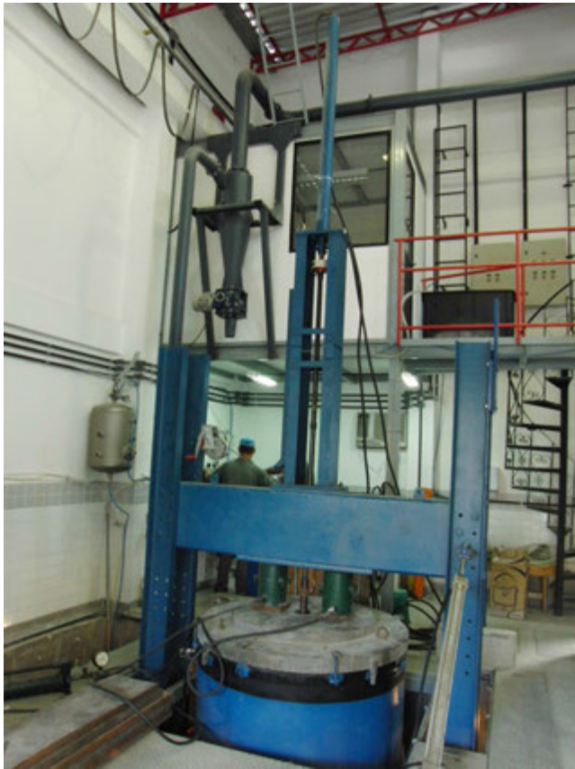
Figura 7.11 – Montagem do ensaio de cravação estática do amostrador SPT.
