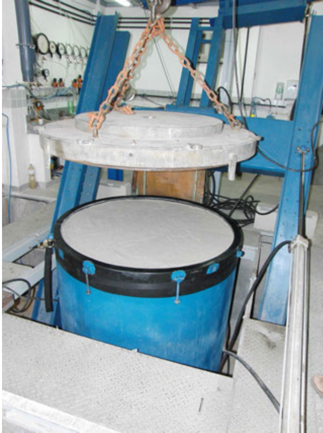
Figura 7.3 – Amostra de areia após pluviação e nivelamento.
