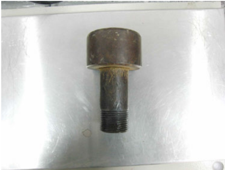
Figura 6.2 – Cabeça de bater utilizada nos ensaios em Sarapuú II.
