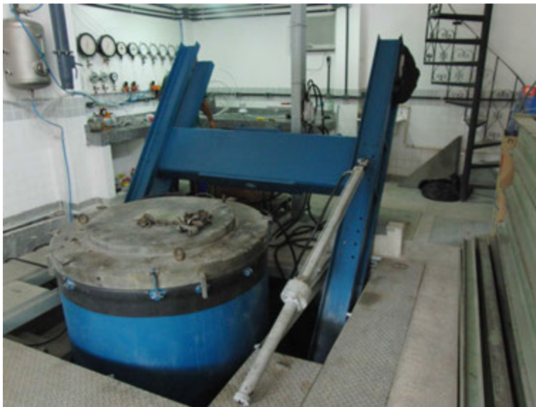
Figura 3.13 – Foto da câmara de calibração e estrutura de reação.
