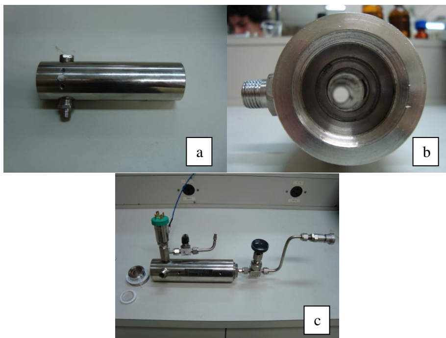
Figura 3.2: Fotos do equipamento. (a), (b) vistas superior e frontal, respectivamente, da célula de equilíbrio de fases; (c) vista das janelas de safira e anéis de vedação ao lado da célula de equilíbrio acoplada aos sensores de pressão, temperatura, válvula acoplada ao
