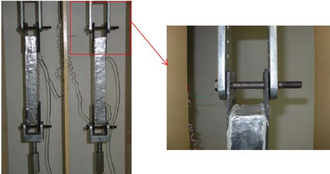
Figura 4.35 – Detalhes referentes à colagem das placas na amostra e ao sistema de transferência de cargas por meio de pinos entre o pórtico e a amostra ([62]).
