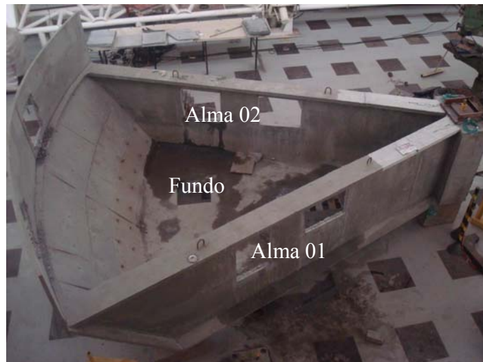
Figura 8.44 – Indicação das regiões de onde foram extraídas amostras do protótipo do flutuador para realização de ensaios mecânicos à flexão e verificação da distribuição do reforço fibroso.
