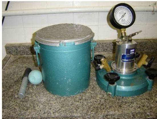
Figura 4.8 – Aparelho para medir o teor de ar aprisionado e incorporado no concreto.
