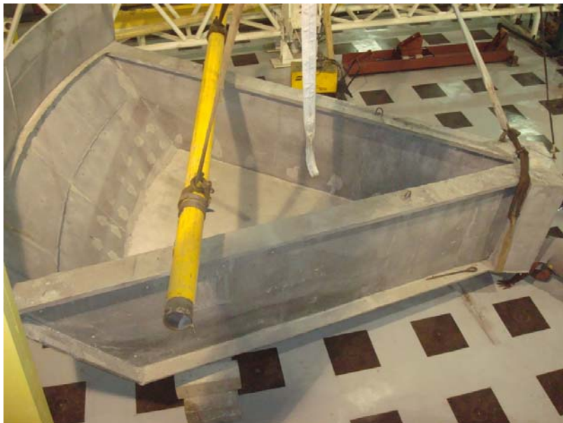
Figura 8.24 – Protótipo (peso próprio \approx 30 kN) sendo transportado para posição dos ensaios.
