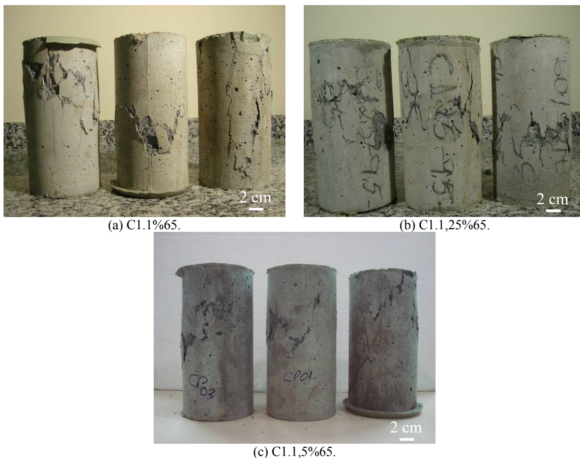
Figura 6.7 – Modo de fratura dos corpos-de-prova dos concretos do tipo C1 reforçados com fibra, submetidos ao ensaio de compressão uniaxial.
