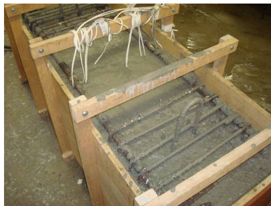
Figura 4.41 – Procedimento para concretagem dos blocos.
