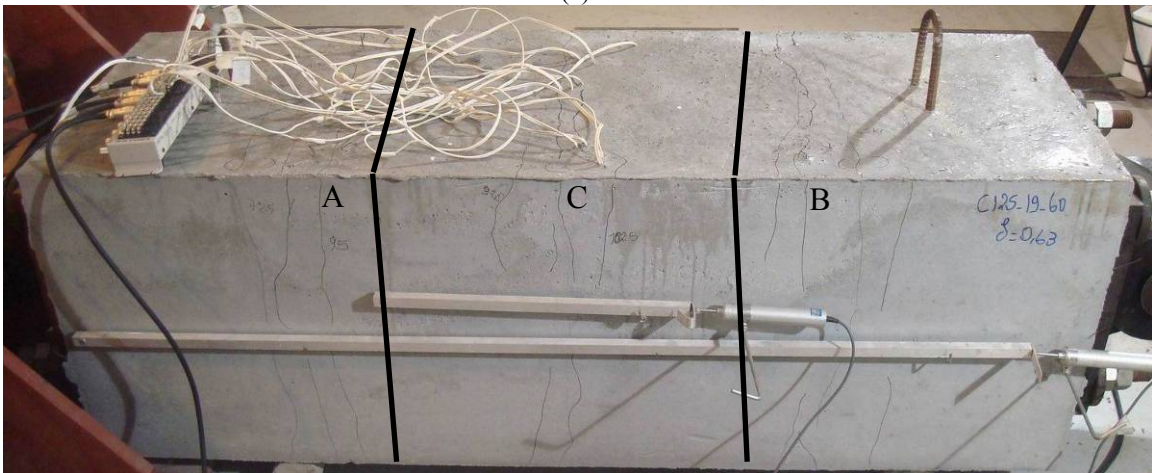
Figura 8.7 – (a) Curva carga x abertura da fissura e (b) Panorama de fissuração do bloco B3 ao final do ensaio.
