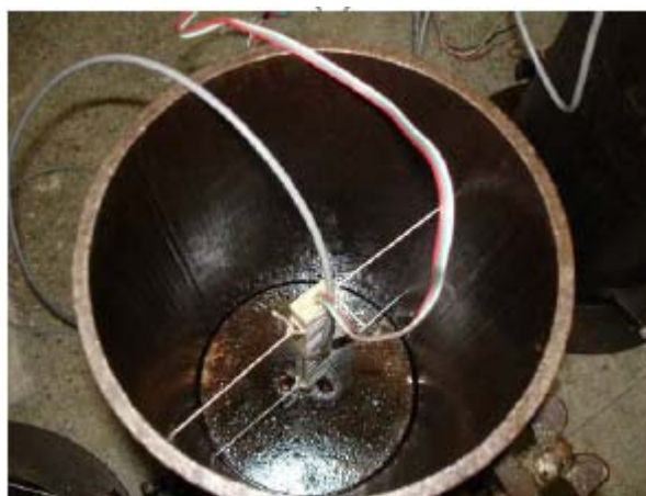
Figura 4.30 – Fixação do termômetro e do extensômetro no molde ([62]).
