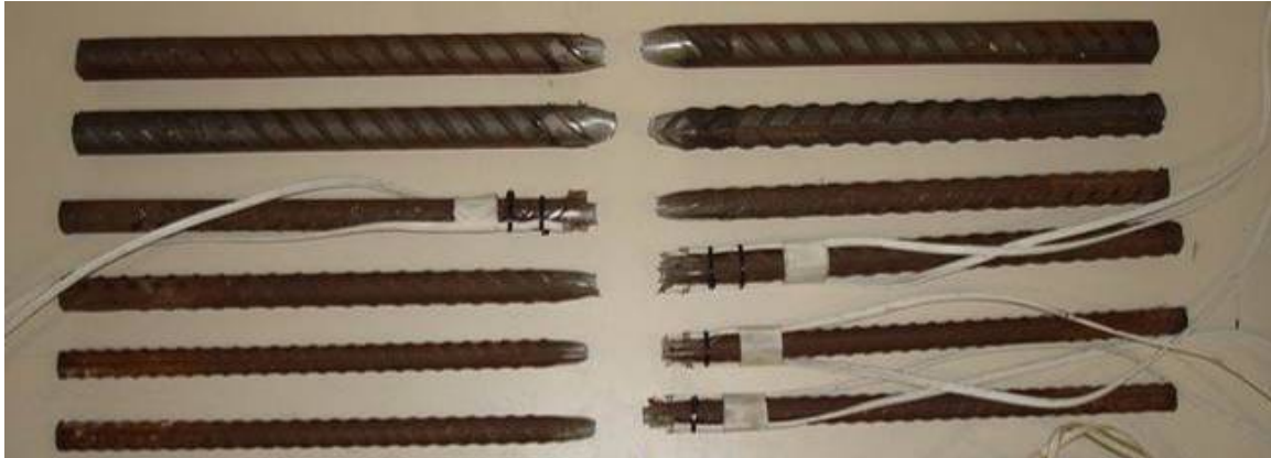
Figura 3.14 – Modo de ruptura das barras de aço ensaiadas à tração direta.
