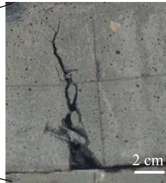
(a1) Ampliação do modo de Fratura (C2.1%65).
