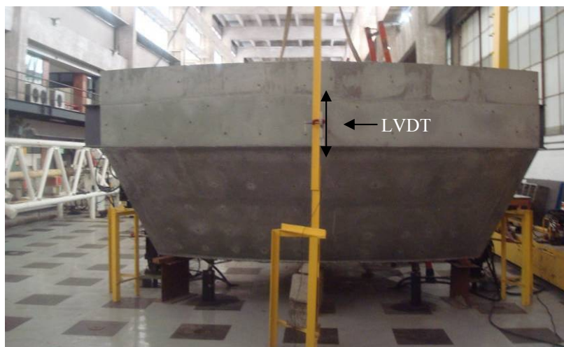
Figura 8.30 – Posição do LVDT para medida do deslocamento vertical na extremidade do protótipo.
