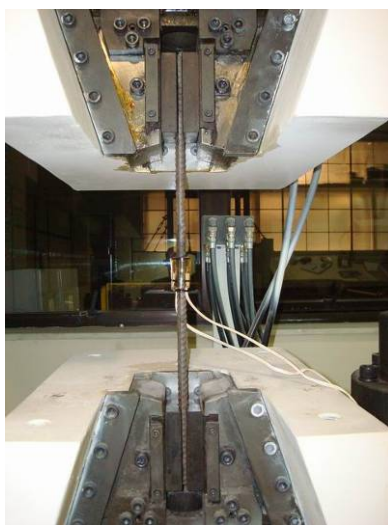
Figura 3.12 – Instrumentação de corpo-de-prova para ensaio de tração direta da barra de aço.
