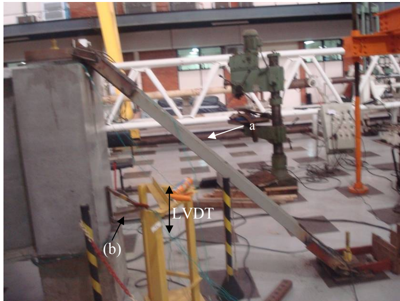
Figura 8.29 – Sistema de engastamento elástico na placa de reação. (a) Placa de ancoragem e tirante – perfil C de aço; (b) sistema para medida de movimento de corpo rígido.
