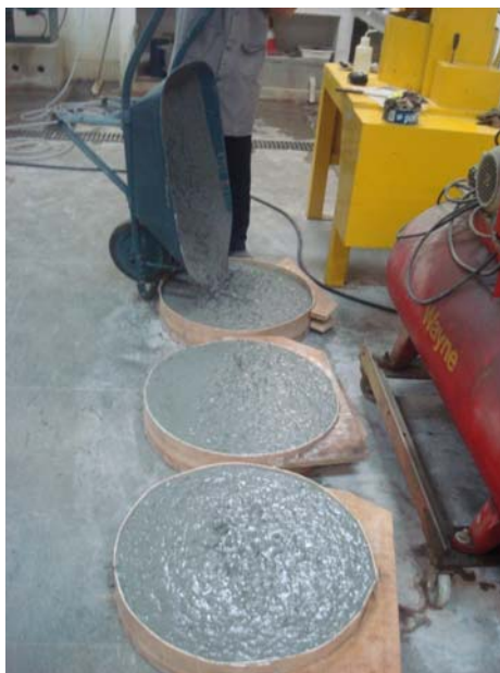
Figura 4.23 – Concretagem dos painéis circulares.
