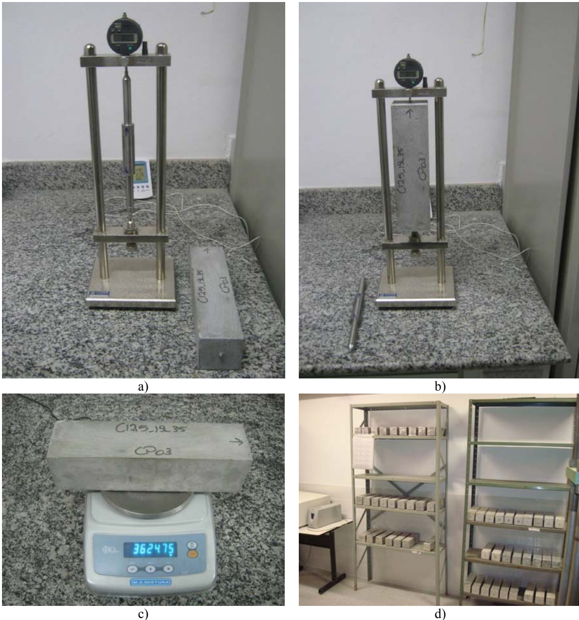
Figura 4.29 – Etapas do ensaio de retração por secagem: a) Barras de referência de Invar; b) Leitura das variações de retração por secagem no relógio comparador; c) Verificação da perda de massa; d) Acondicionamento das amostras após as leituras.
