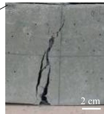
(c1) Ampliação do modo de Fratura (C2.1,25%65).
