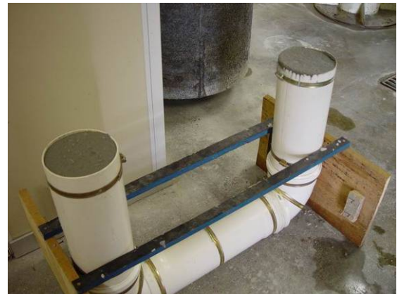
(b) Tubo "U" preenchido de concreto.
