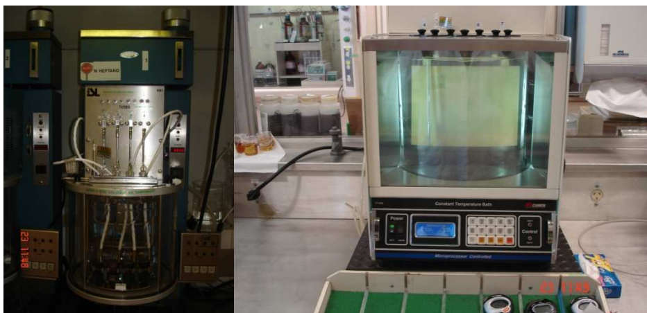
Figura 20: Equipamentos para medição da viscosidade cinemática.
