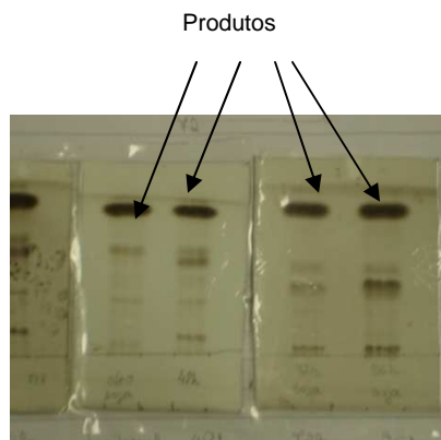
Figura 29: Placa de TLC mostrando a reação de transesterificação entre biodiesel metílico de soja e TMP com enzima Lipomod 34P (Biod/TMP=4,5:1, T=42°C, C água =12%, C enzima =0,8%, Pressão reduzida=0,01bar).
