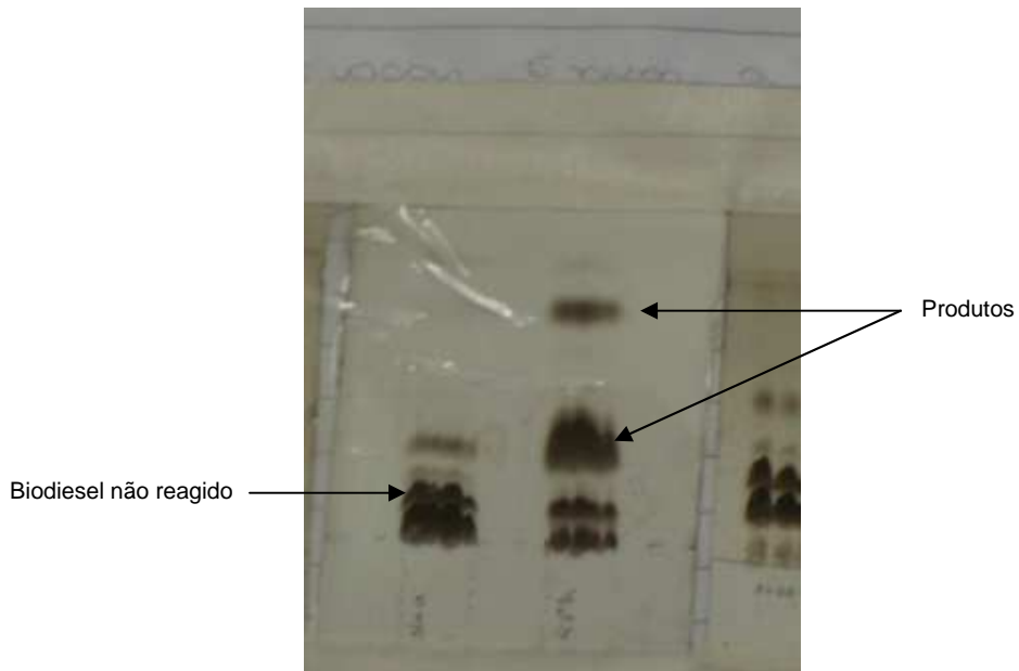
Figura 27: Placa de TLC mostrando a reação de transesterificação entre biodiesel metílico de mamona e TMP com enzima Lipomod 34P (Biod/TMP=4,5:1, T=42°C, C água =12%, C enzima =0,8%, Pressão reduzida=0,01bar).
