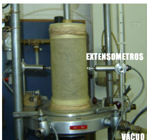
Figura 3.15. Ensaio triaxial aplicando vácuo.
