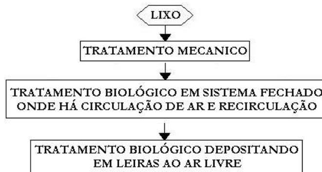
Figura 2.4. Esquema operacional do sistema KIRCHDORF (Fricke et al, 1995).
