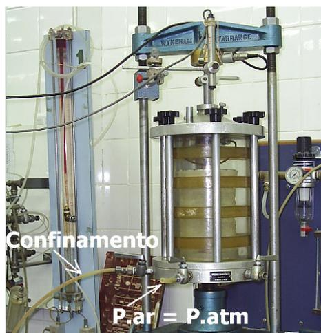
Figura 3.14. Corpo de prova pronto para ensaio triaxial.
