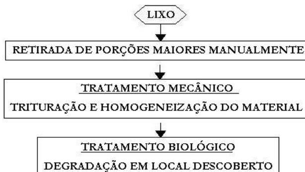
Figura 2.1. Esquema operacional do sistema FABER AMBRA (Faber Ambra Recycling, 1999).
