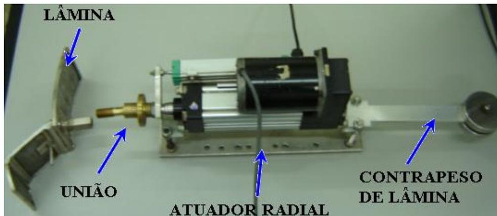
Figura 3.24. Atuador radial e lâmina.
