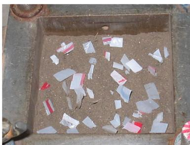
*Figura 3.16. Ensaio de cisalhamento – Adição de plástico no resíduo triturado.*
