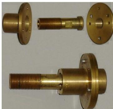
Figura 3.23. União de aço de lâmina metálica com atuador radial.
