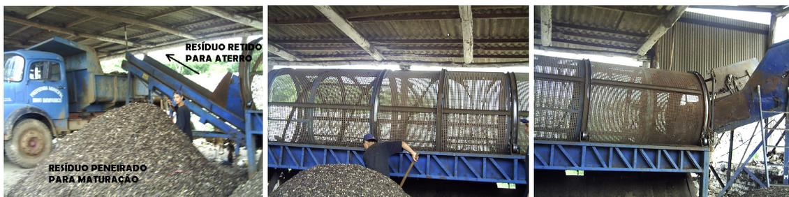
a) Retido para caminhão (Aterro). b) Peneiramento a 10, 15 e 20 mm. c) Ingresso do resíduo estabilizado.
