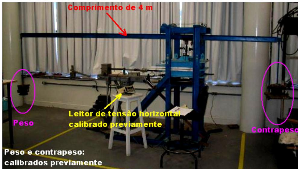
Figura 3.17. Ensaio de grande dimensão no ITA – Aparelhos calibrados.
