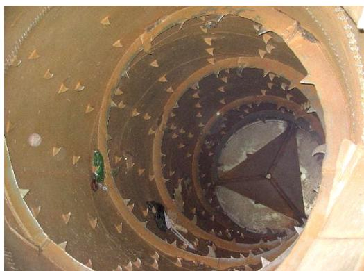
*Figura 3.5. Detalhe trituração e homogeneização do resíduo no interior de um caminhão.*
