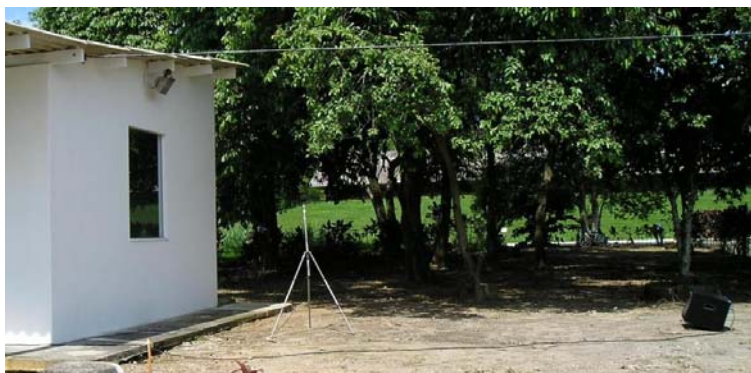
Figura 6.42 - Medição de isolamento sonoro global de fachada com alto-falante, local 1.
