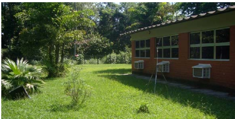
Figura 6.43 - Medição de isolamento sonoro global de fachada com alto-falante, local 2.
