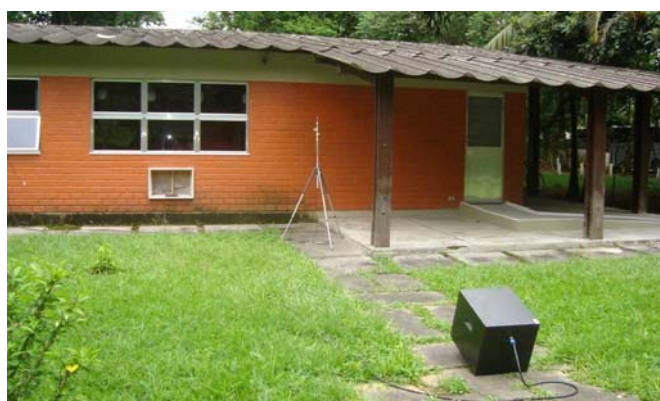
Figura 6.45 - Medição de isolamento sonoro global de fachada com alto-falante, local 4.
