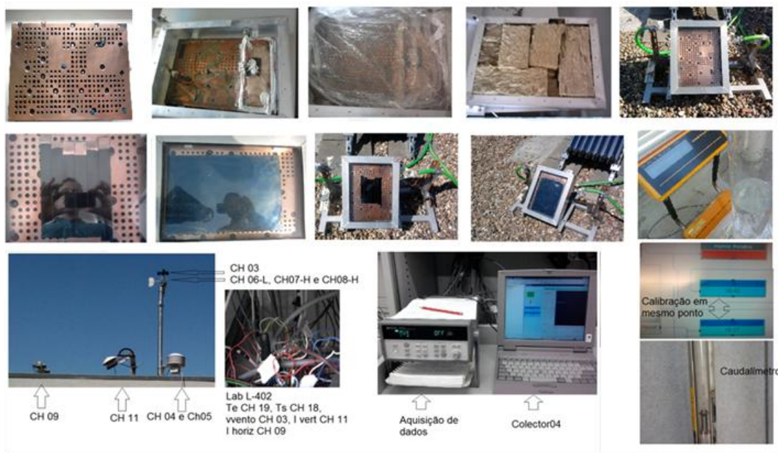
Figura 5.54. Instalação experimental com sistema de aquisição para o coletor solar com tubos de calor em placa.
