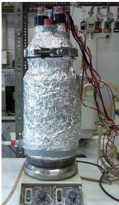
Figura 3.5 Reator utilizado para as reações de UV/H<sub>2</sub>O<sub>2</sub>
