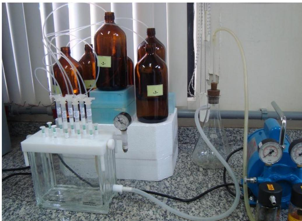
Figura 3.6 Foto do sistema utilizado para EFS.
