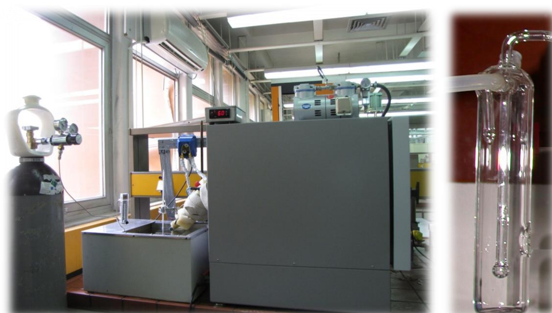
Figura 7.5 Unidade de polimerização de PET em estado sólido e saturador no LPT
