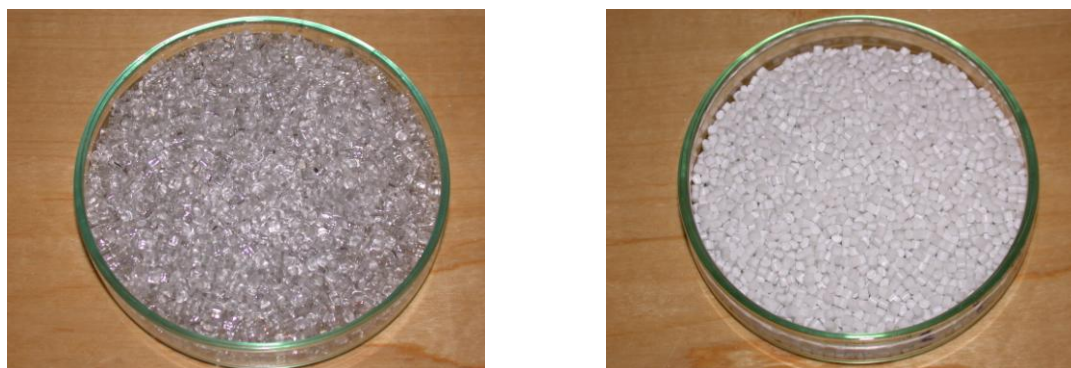
Figura 2.4 PET Amorfo (Precursor - à esquerda) e PET Semi-Cristalino (Produto final - à direita) da SSP
