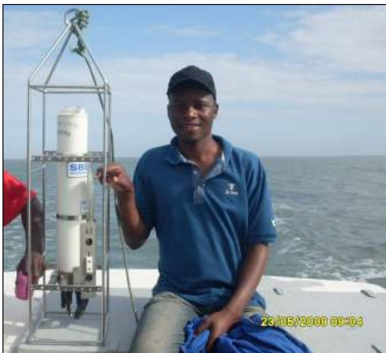
**Figura 17:** Instrumento de medição de condutividade, temperatura e profundidade (CTD) e operador.
