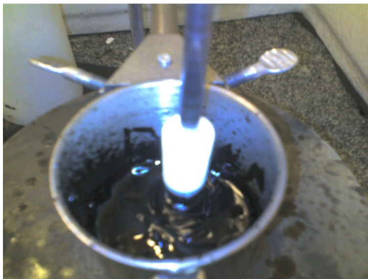
Figura 58 – Misturador do ligante com o polímero
