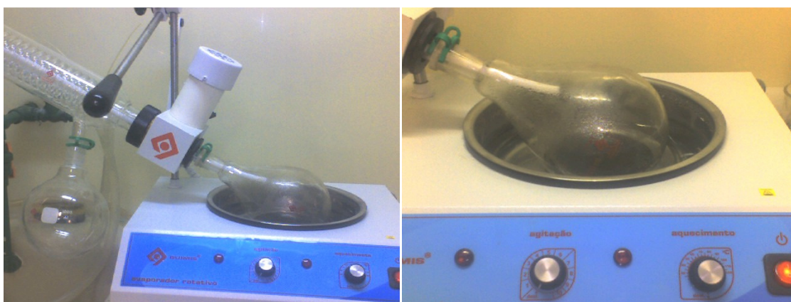
Figura 30 - Evaporador Rotatório utilizado no procedimento de separação
