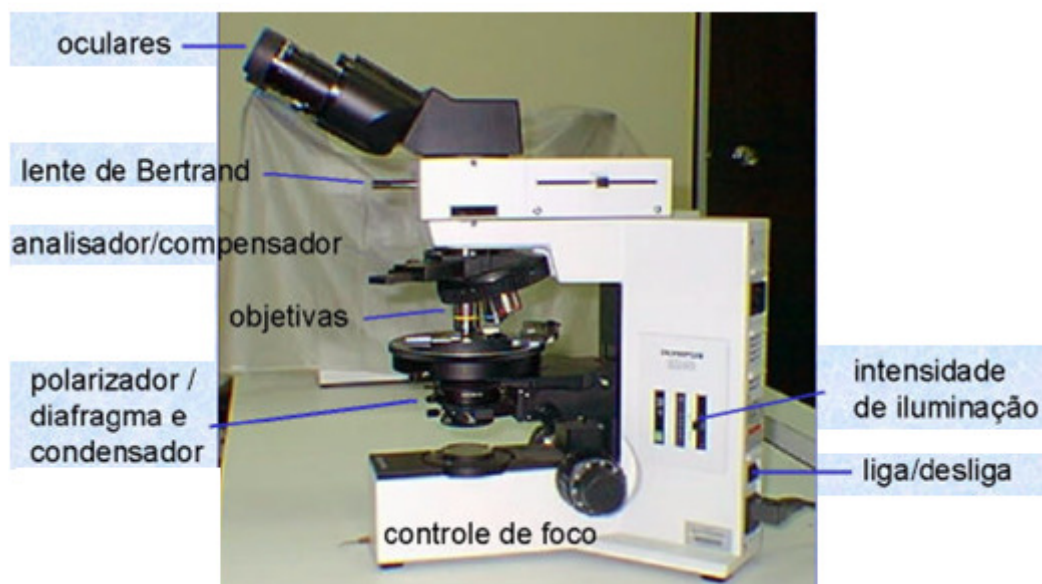
Figura 31 – Microscópio Ótico Olympus utilizado nas análises morfológicas
