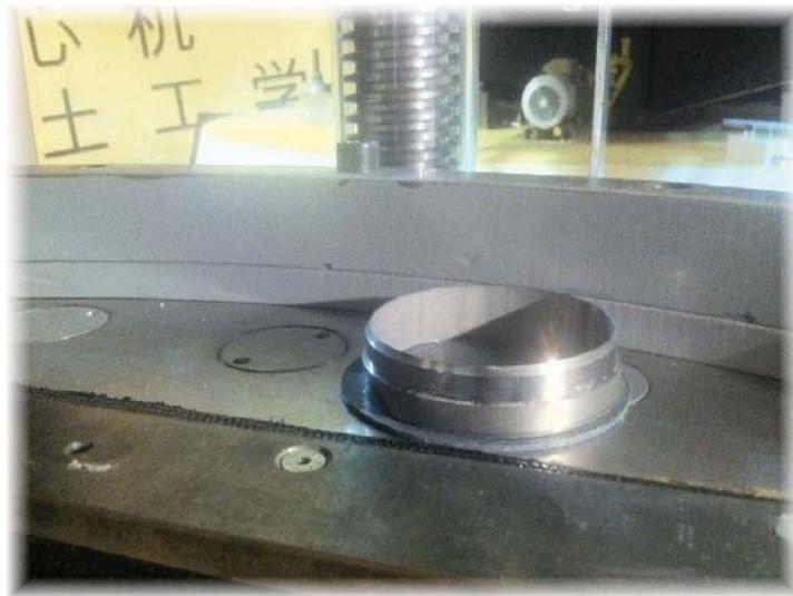
Figura 3.21: Anel para medida da densidade.
