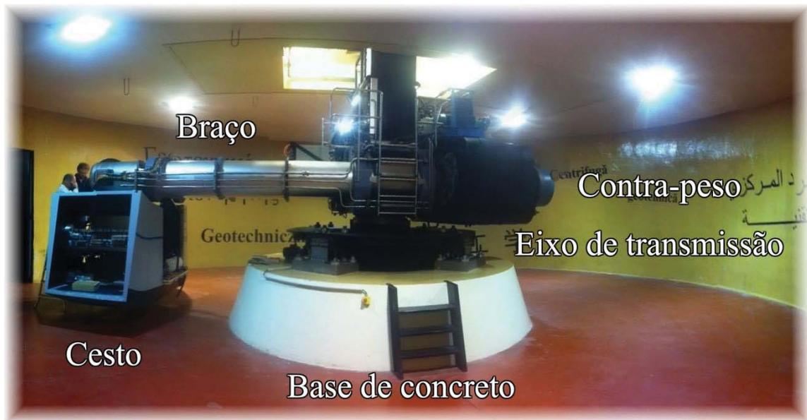
Figura 3.1: Visão geral da centrífuga do IFSTTAR.
