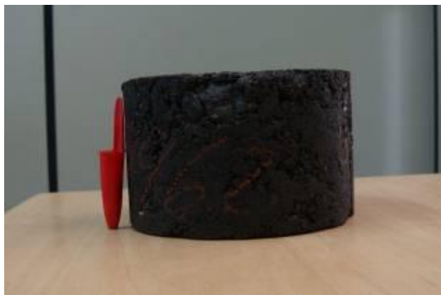
Figura 51: Exemplo de corpo de prova, \phi 100 mm, usado nos ensaios de MR.
