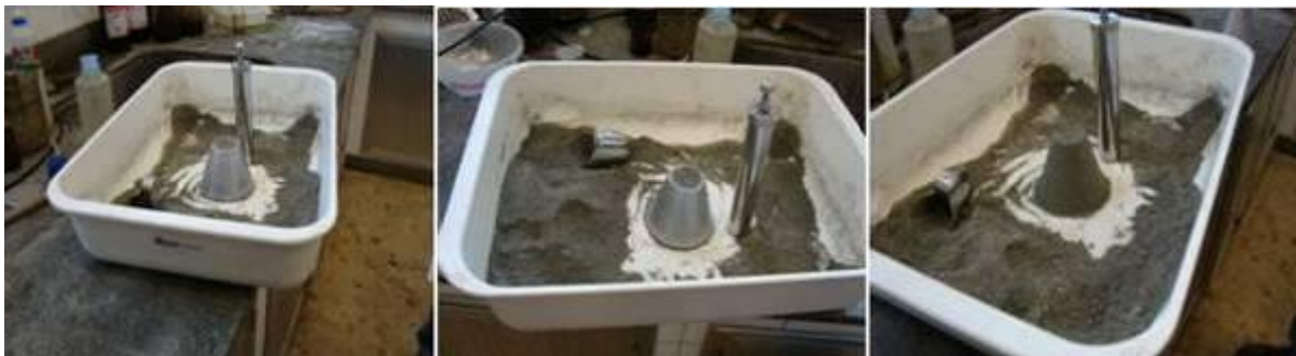
Figura 32: Etapas do ensaio de Densidade do agregado miúdo - definição do ponto de superfície saturada e seca.
