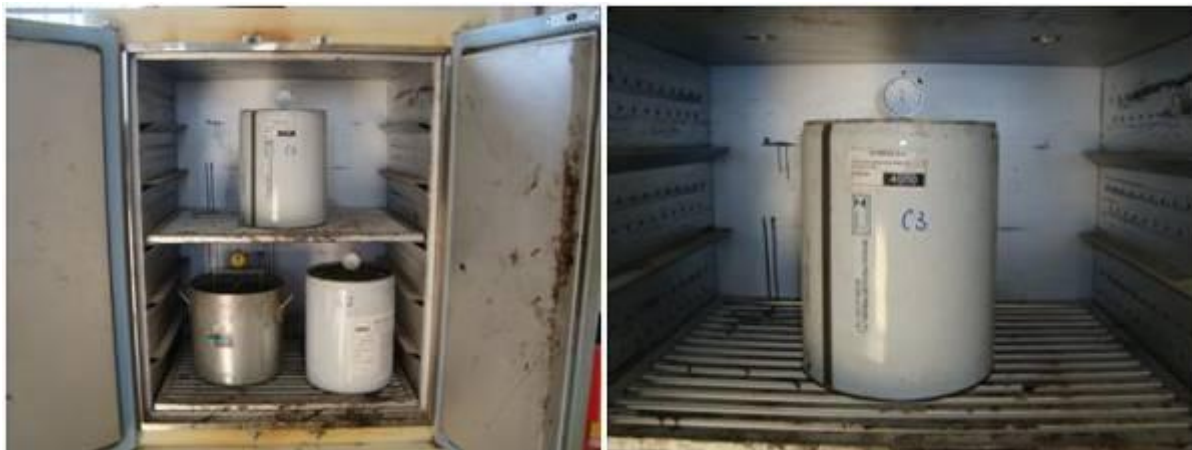
Figura 34: Recipientes contendo os CPs dentro da estufa no ensaio de expansão.
