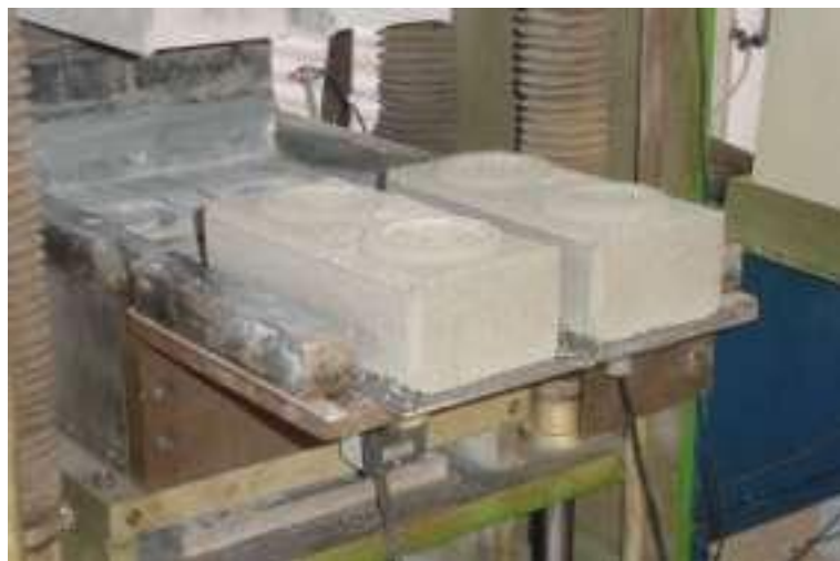
Figura 8: Blocos produzidos com escória de aciaria (CESAR, 2008).
