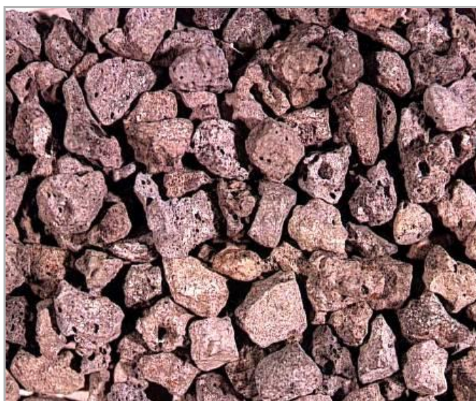
Figura 25: Aspecto dos grãos graúdos de agregados siderúrgicos ingleses (JONES, 2006).
