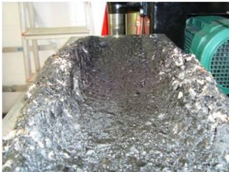
Figura 75: Deformação final da placa da M02 deste estudo no simulador LCPC.
