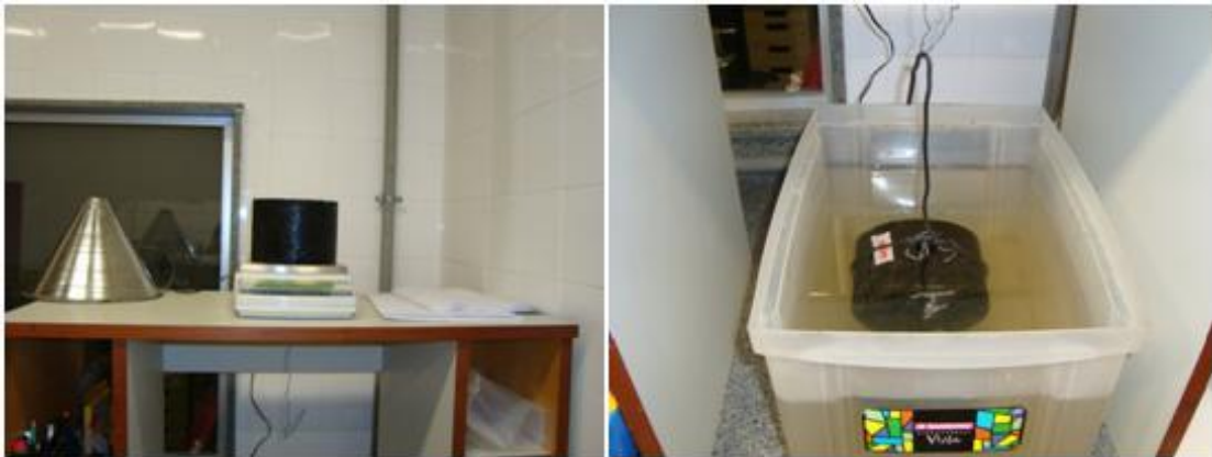
Figura 43: Pesagem dos corpos de prova, seco e imerso, para obtenção da massa específica aparente.
