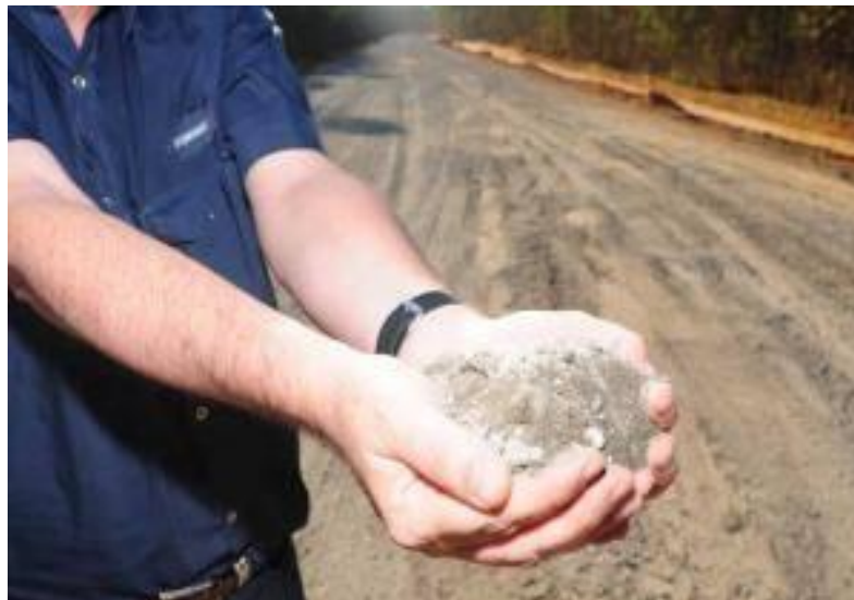
Figura 18: Utilização da escória como agregado rodoviário ( www.jornalvaledoaco.com.br - consulta: 8/2/2011).
