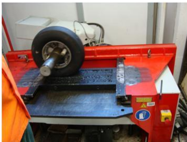
Figura 60: Mesa compactadora usada na fabricação das placas para o ensaio no simulador LCPC.
