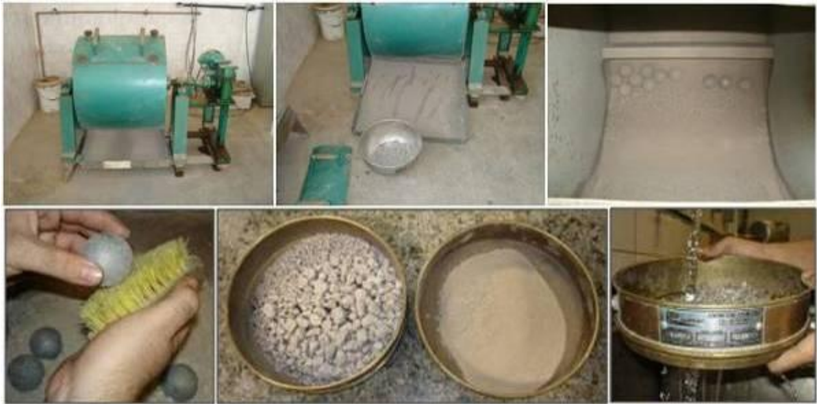
Figura 33: Passos do ensaio de abrasão Los Angeles.
