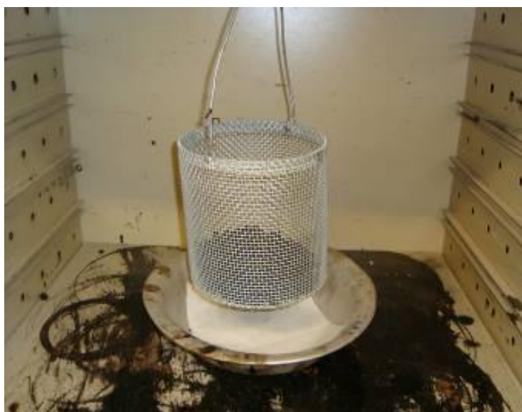
Figura 49: Conjunto do ensaio de escorrimento na estufa.
