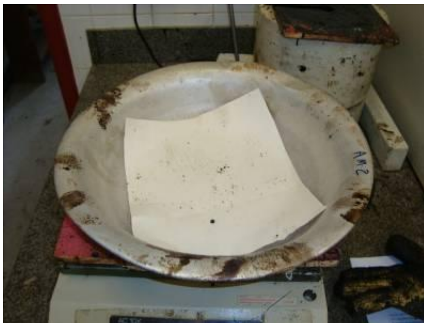
Figura 50: Resultado do ensaio de escorrimento da M01 deste estudo.
