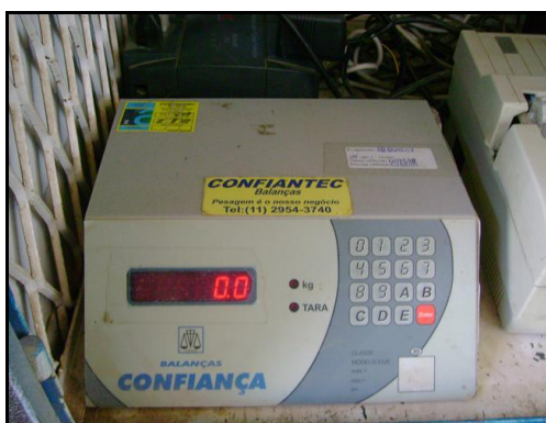
Figura 4.5: B- Balança eletrônica, marca Confianteq – modelo 312E, com capacidade de 500 kg, (Unidade de Tratamento de RSS – CTR-NI).
