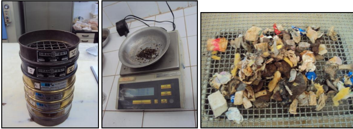
Figura 4.34: A- Peneiramento com série de peneiras granulométricas. B- Pesagem do resíduo passante da peneira 8. C- Fração não passante da peneira 5/16” (Classificação por tamanho da peça).
