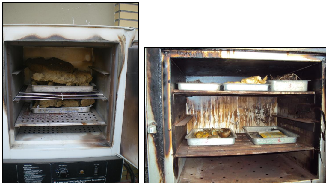
Figura 4.21: Secagem das amostras na estufa a uma temperatura de 50°C.
