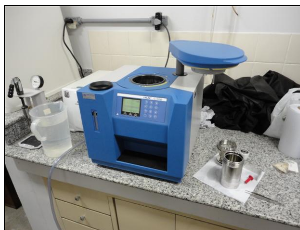
Figura 4.11: Bomba calorimétrica automática, marca IKA – modelo C200.
