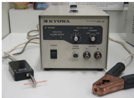
Figura 3.2.6 – Máquina utilizada para soldagem dos extensômetros nos corpos de prova.
