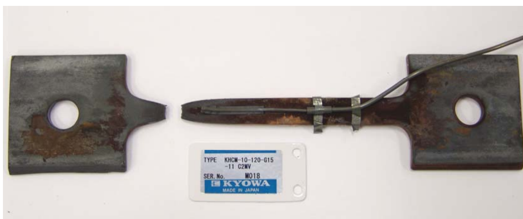
Figura 4.2.3 – Amostra CP600_150_1: ensaio a 600°C e tensão de 150 MPa. A estricção e o rompimento do corpo de prova ocorreram fora da região onde o extensômetro estava soldado.
