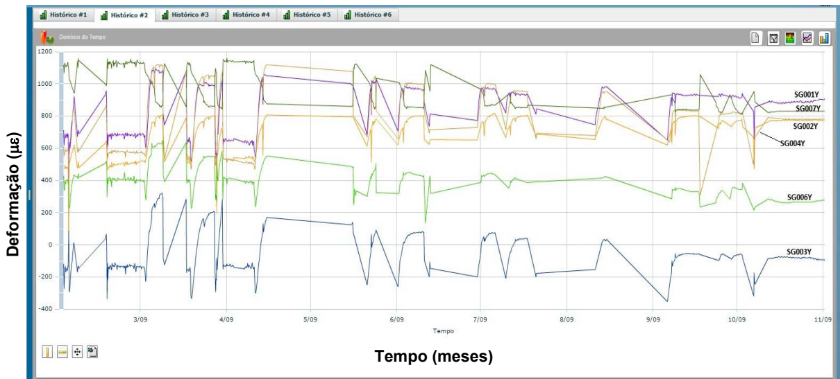
Figura 4.3.5 - Histórico de evolução da deformação na direção longitudinal durante os meses de fevereiro e dezembro de 2009, da linha de vapor principal. Observação: 1000\mu\epsilon = 0,1\%
