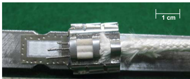
Figura 3.2.4 – Foto do extensômetro HPI, soldado em um corpo de prova.
