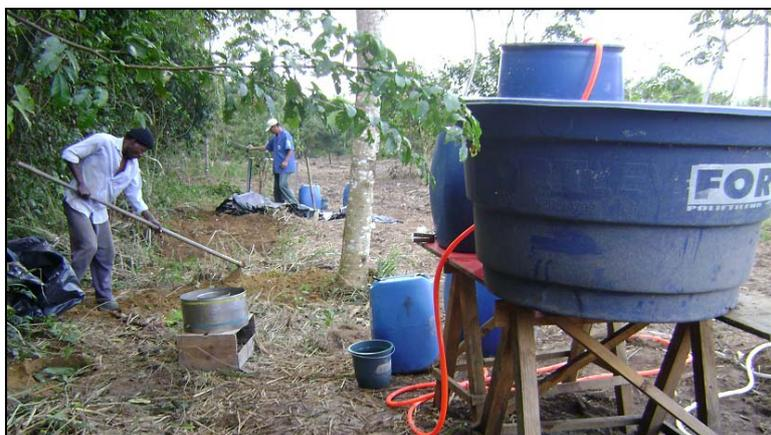
**Figura 4.9:** Reservas de água utilizada nos testes de capacidade de campo e infiltração.
