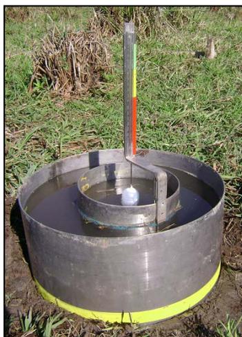
**Figura 4.10:** Infiltrômetro de duplo anel.
