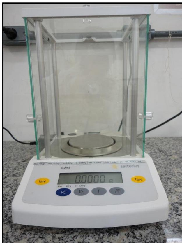
**Figura 42 - Balança de alta precisão (Sartorius AG - Alemanha) utilizada na pesagem das substâncias para a obtenção das soluções usadas na pesquisa.**
