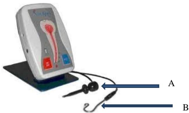
**Figura 39 - Localizador apical. (A) Eletrodo que entra em contato com a mucosa bucal. (B) Eletrodo que se adapta à lima endodôntica manual**
