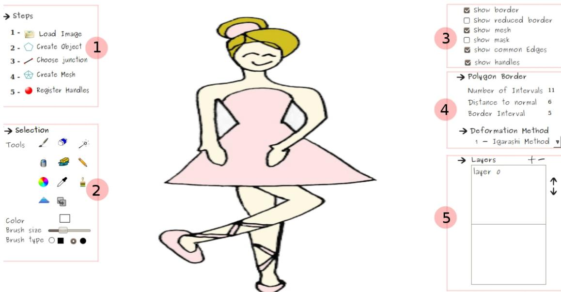
Figura 3.7: Interface proposta: 1- Roteiro de tarefas; 2- Ferramentas de edição e manipulação de camadas; 3- Opções de Visualização; 4- Opções de Segmentação; 5- Preview e ordenação das camadas.
