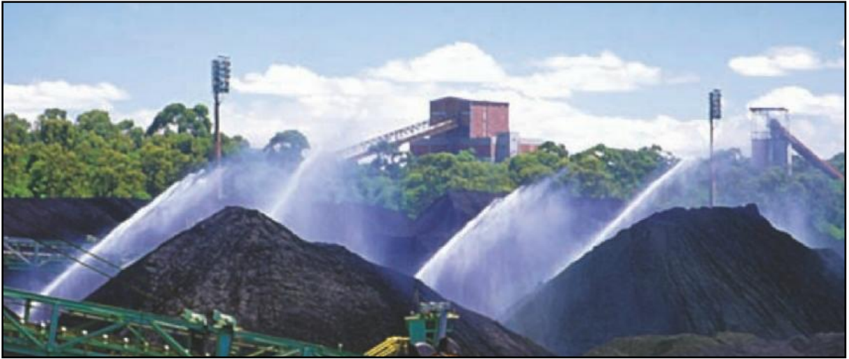
Figura 2.18 – Operação de aspersão de pilhas em pátios de matérias primas (ABM, 2012).
