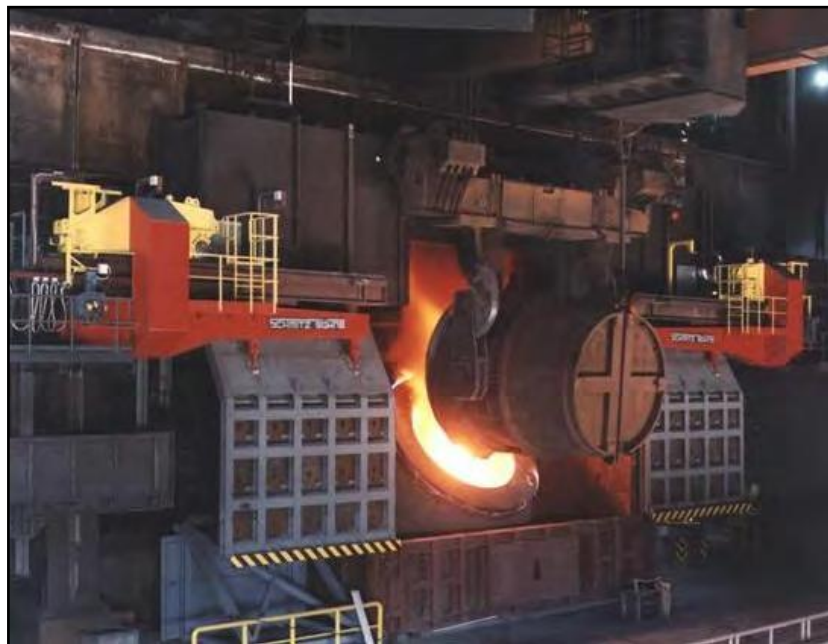
Figura 2.35 – Carregamento de ferro gusa no conversor LD, com auxílio de pontes rolantes (IPCC, 2012).
