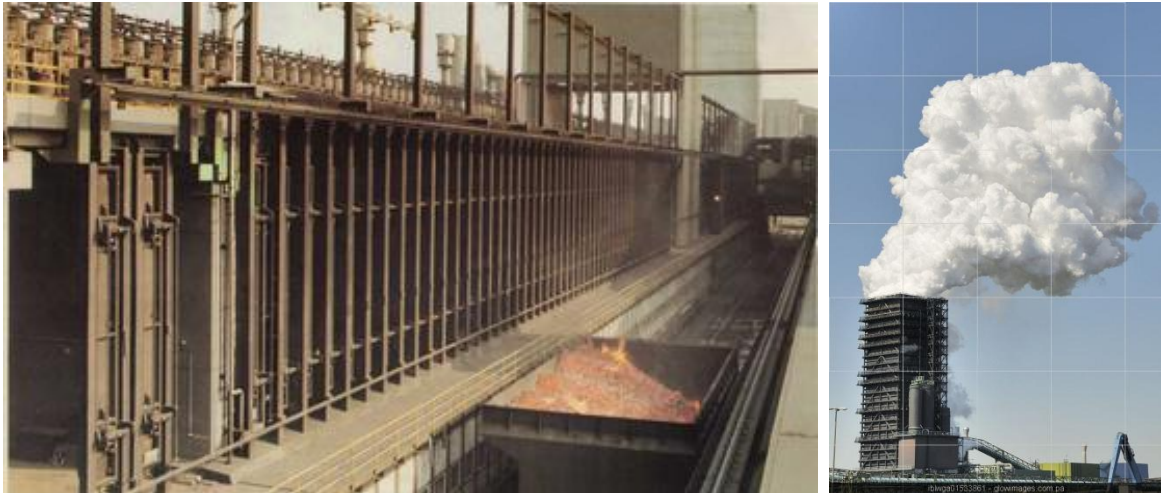
Figura 2.24: Bateria de fornos de uma coqueria, com coque incandescente recém-descarregado (esq.) (AISI, 2012) e torre de apagamento úmido de coque (dir.) (GLOWIMAGES, 2012).
