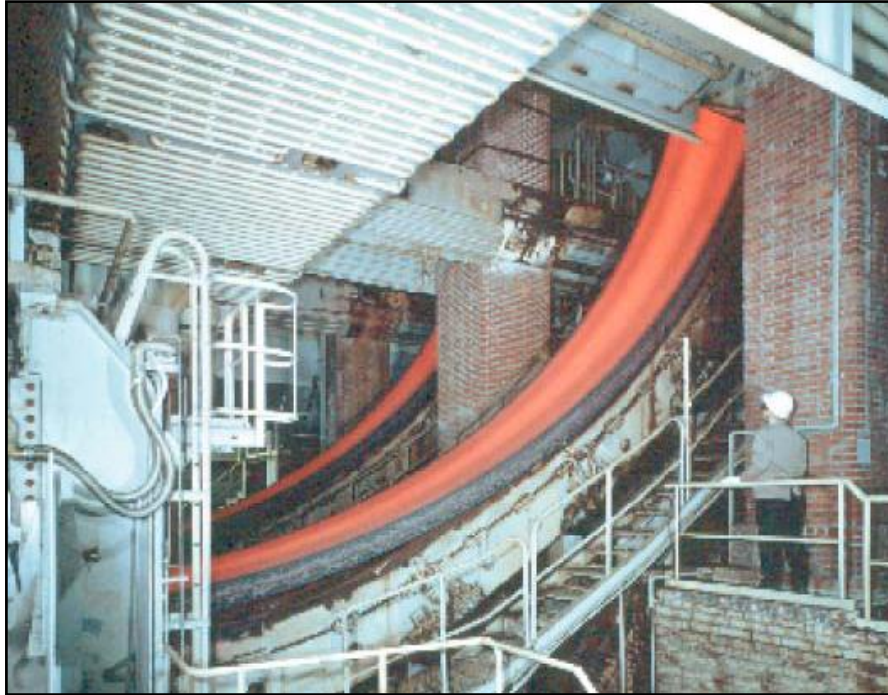
Figura 2.40 – Máquina de lingotamento contínuo em operação (IRON AND STEEL INDUSTRY, 2012).
