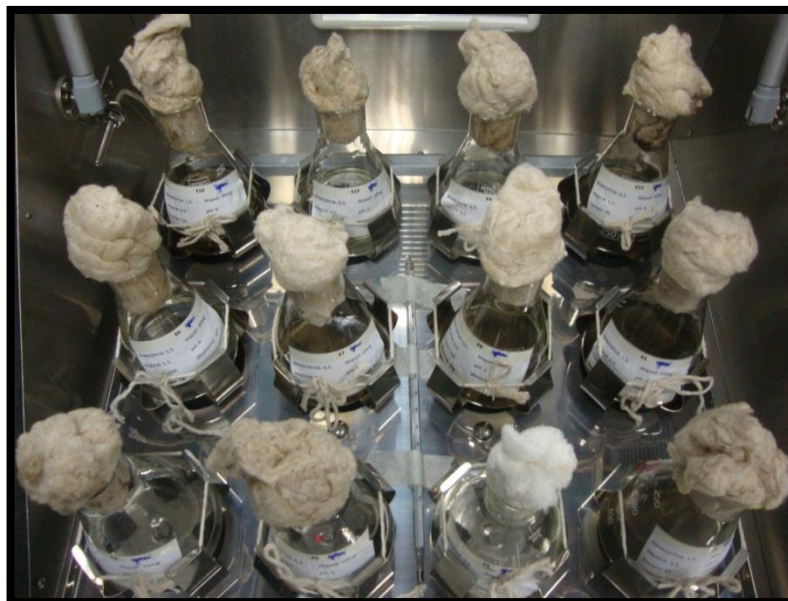
Figura 6. Imagens dos frascos Erlenmeyers contendo as soluções de níquel e conídios dispostos em agitador rotatório para avaliação da biossorção.
