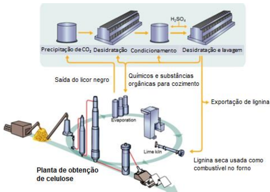
Figura 20: Esquematização da tecnologia LignBoost, em uma das primeiras plantas elaboradas. Fonte: Adaptado de VALMET, 2016.
