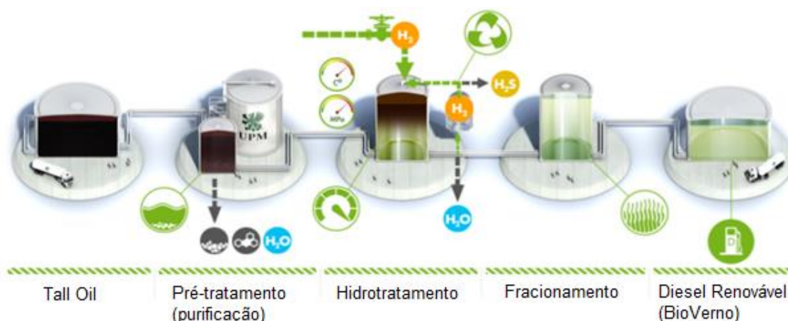
Figura 15: Etapas do processo de produção do BioVerno. Fonte: Adaptado de UPM BIOFUELS, 2016.
