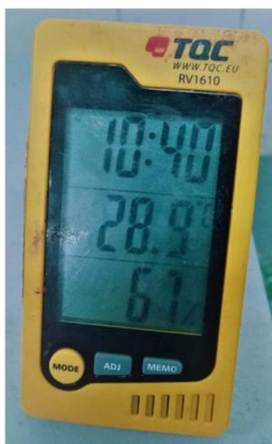
**Figura 39 – Instrumento para medição das condições do ambiente da câmara de pintura.**
