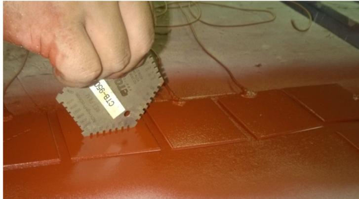
**Figura 42 – Medição de espessura da camada de tinta úmida.**
