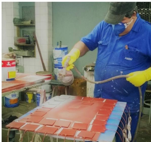
**Figura 40 – Aplicação da tinta utilizando pistola convencional.**
