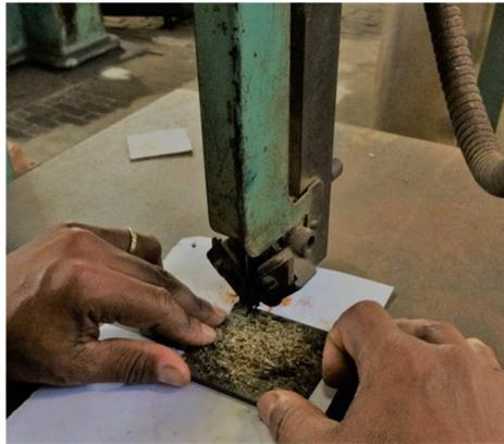
**Figura 55 – Corte de uma amostra do CP para ensaio de MEV e EDS.**
