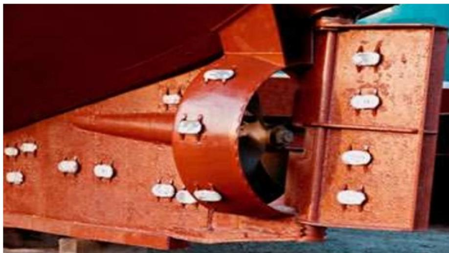
**Figura 4 – Instalação de anodos galvânicos na região de turbulência do eixo de transmissão de uma embarcação.**
