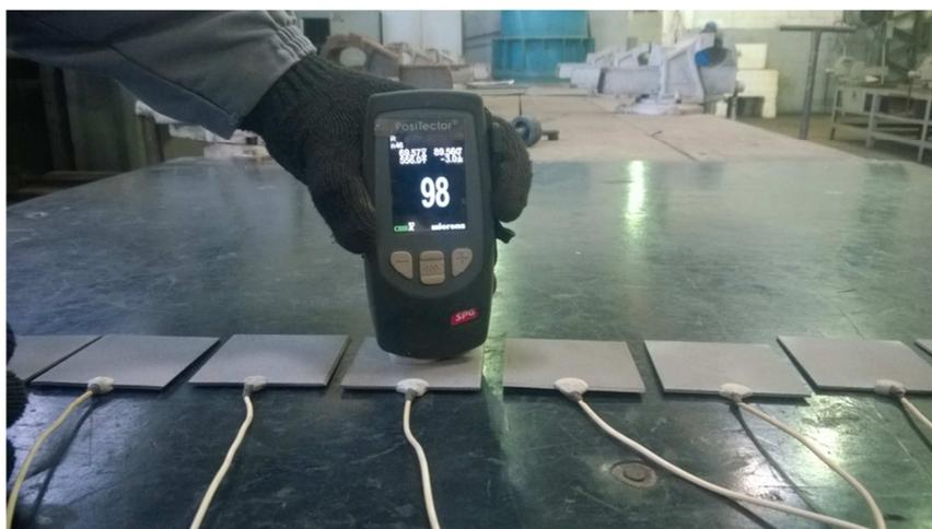
Figura 38 – Medição do perfil de rugosidade dos corpos de prova após jateamento abrasivo com granalhas de aço angulares.
