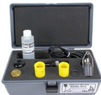
Figura 51 – Kit para leitura de potencial eletroquímico em água do mar.
