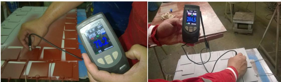
**Figura 43 – Medição da espessura da camada de tinta seca.**
