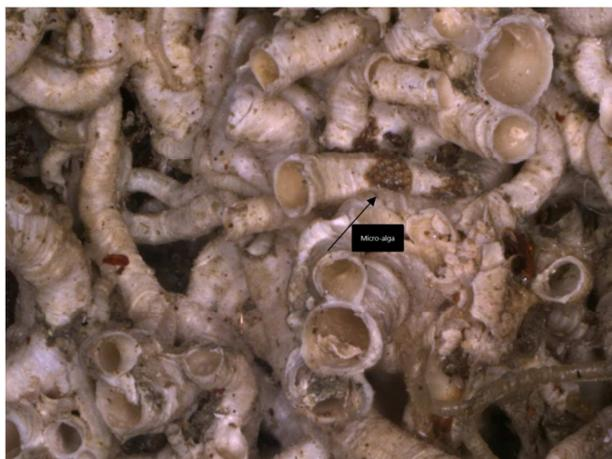
**Figura 105** – Destaque para a estrutura de uma micro-alga encontrada nos depósitos calcários formados sob a proteção catódica galvânica com anodos de Zn e tempo de exposição de 150 dias.
