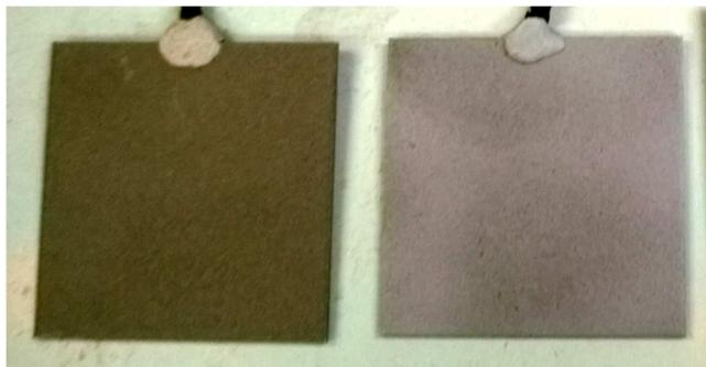
**Figura 37 – Comparação entre o corpo de prova antes e depois do jateamento abrasivo com esferas de vidro.**
