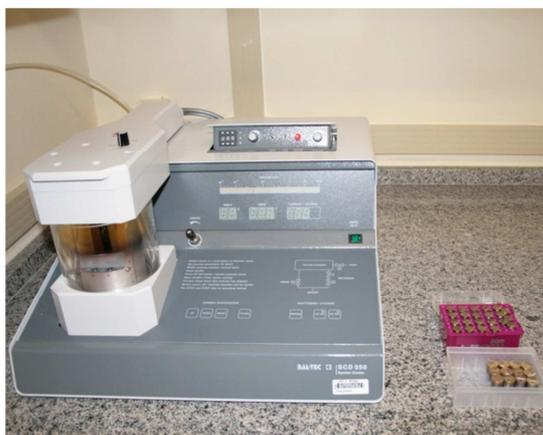
**Figura 29 - Equipamento utilizado para recobrimento com carbono ou deposição metálica sobre as amostras não condutoras.**
