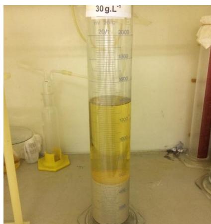
Figura 20 Aspecto visual do efluente e do lodo gerado após aplicação do processo de coagulação-floculação em concentração ideal de coagulante ( 30 \text{ g.L}^{-1} ) (430 mL de lodo gerado por litro de efluente tratado).
