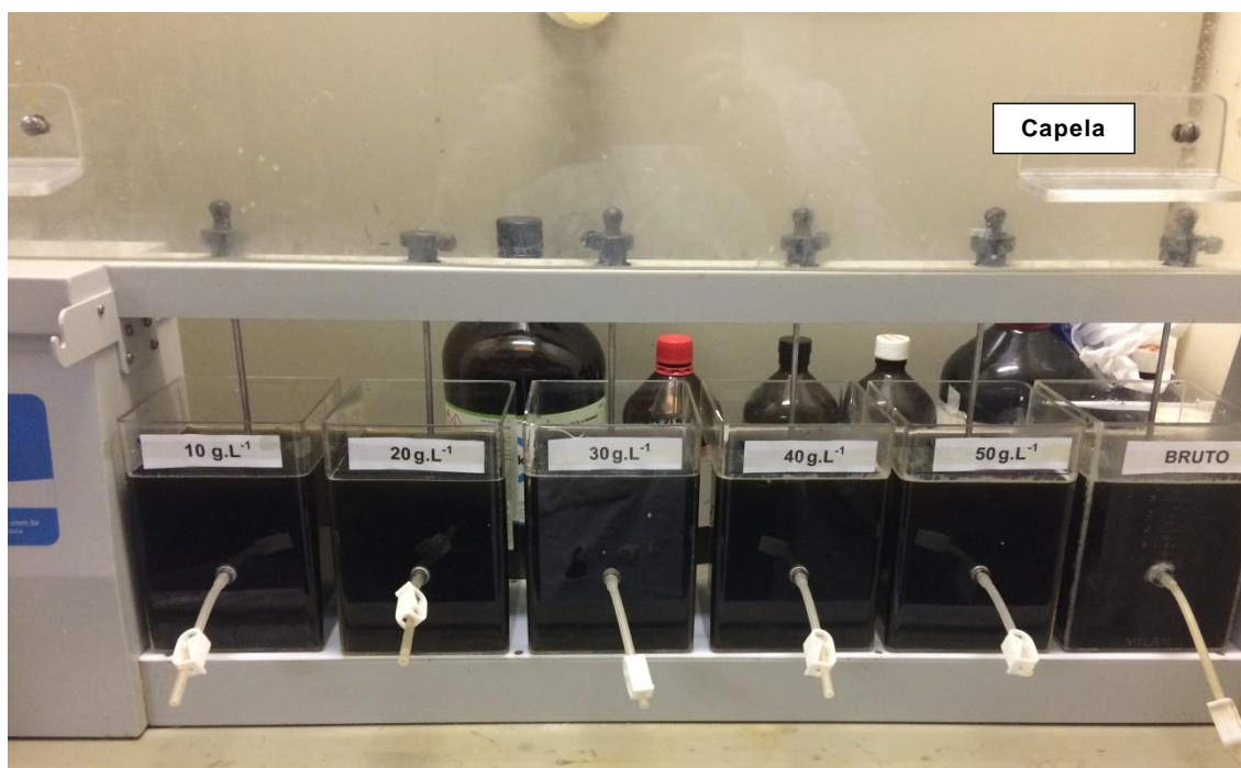
Figura 8 Aparelho de Jar-Test modelo Nova Ética utilizado no processo de coagulação-floculação com cal
