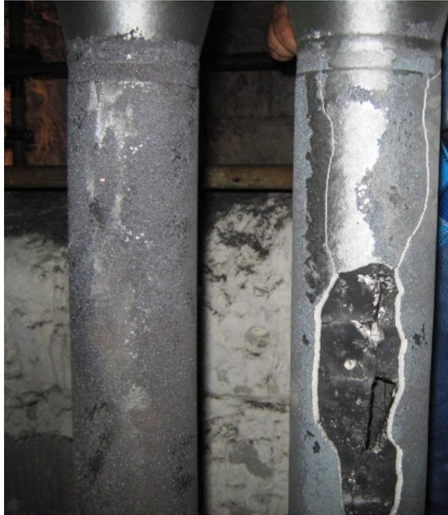
*Figura 3-13 Fratura dúctil em serpentina de forno de pirólise.
