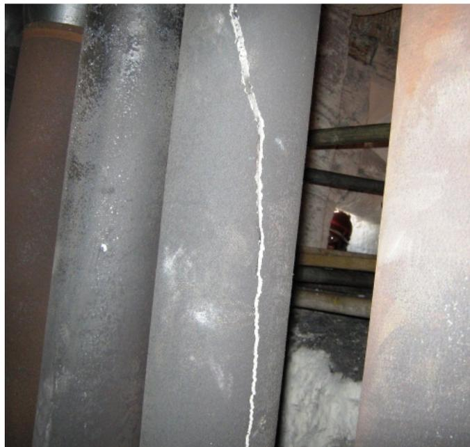
*Figura 3-14 Fratura frágil em serpentina de forno de pirólise.
